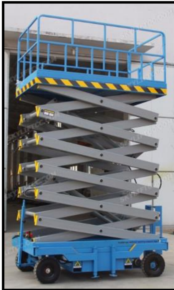
Figur 28 - Eksempel på personlift for utvendig vask
