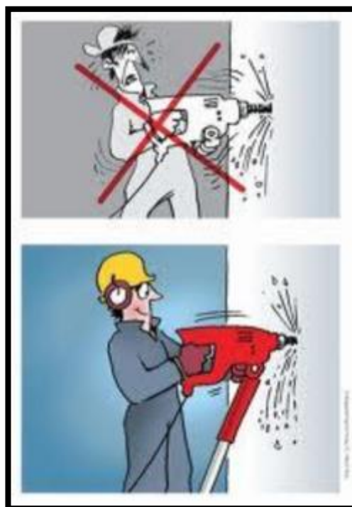
Figur 9 - Vibrerende arbeidsutstyr med og uten personlig verneutstyr
