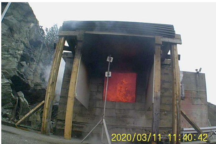
35 minutter etter brannstart (11:40:42) Større flammer og disse begynner å trekke ut av forsøksrommet. Testplatene får nå en større påkjenning.
