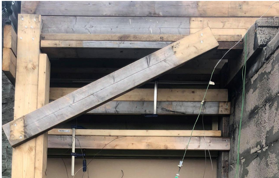
Bilde 7.7 – Planker holder fast termoelementene på platen ved hjelp av treklemmer
