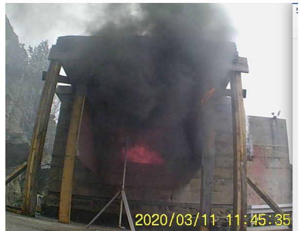
40 minutter etter brannstart (11:45:35) Brannens størrelse øker ytterligere, som følge av økt vindstyrke. Røyken kommer ut helt fra nedre del av vinduskarmen.
