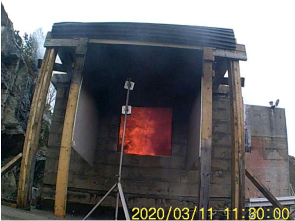
25 minutter etter brannstart (11:30:00) Ikke store endringer etter åpning i gipsen.
