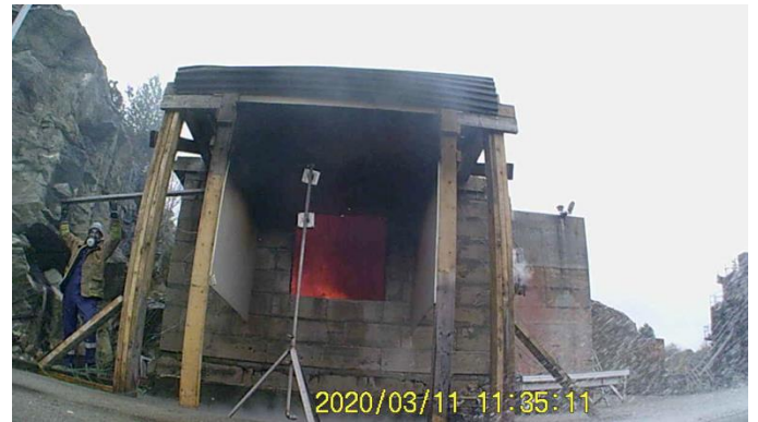
30 minutter etter brannstart (11:35:11) Røyk på bakken, som følge av brann i bensinsøl. Dette ble slokkt. Det utføres bomullstest nr.2. Ikke store endringer i størrelse av brannen.
