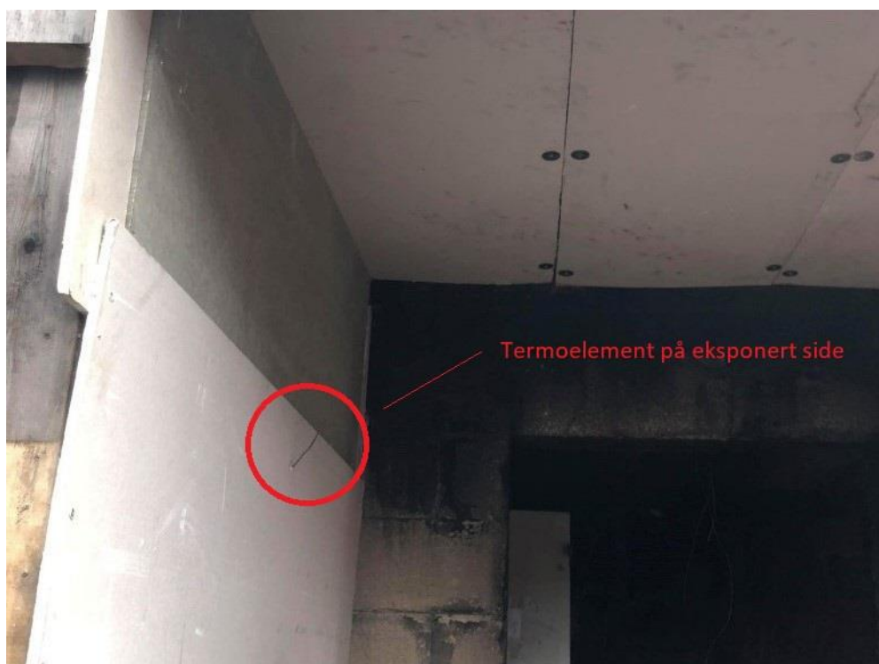
Bilde 7.6 – Termoelement igjennom gipsvegg på den branneksponte siden
