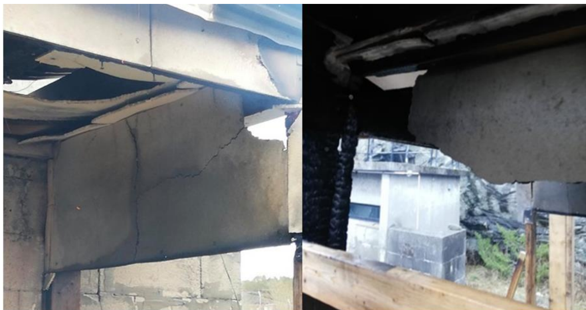
Bilde 8.1 – Eksponert side og deler av ueksponert side til Cetriss
