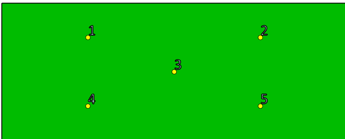
Figur 7.8 – Termoelementene på ueksponert side av Cetris
