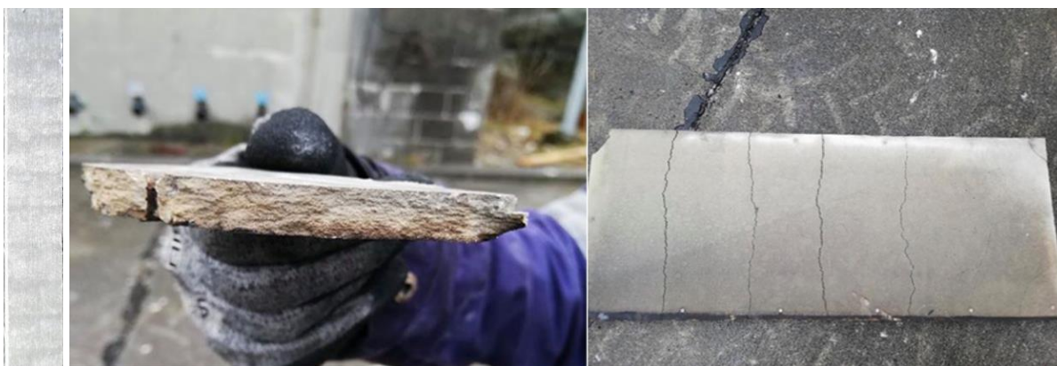
Bilde 8.4 – Tverrsnitt og eksponert side til Construction etter forsøk
