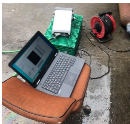
Bilde 7.10 – Oppsett av datalogger og PC
