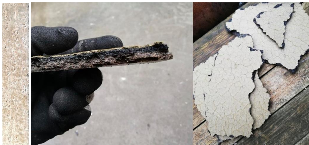
Bilde 8.2 – Tverrsnitt og biter av eksponert side av Cetriss
