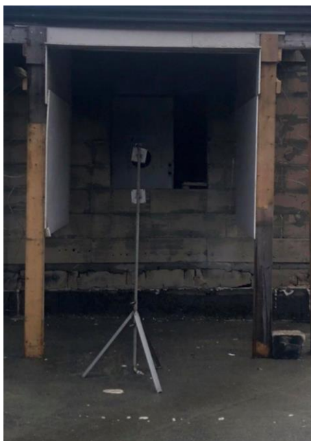
Bilde 7.8 – Platetermometerets plassering
