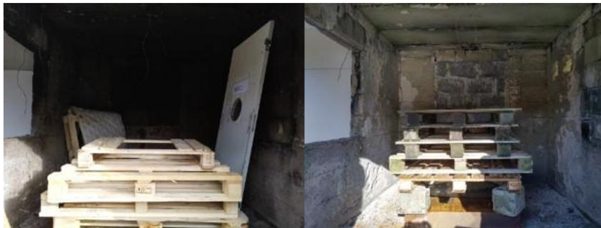
Bilde 7.4 – Henholdsvis brensel under forsøksbrannen og under testbrann
