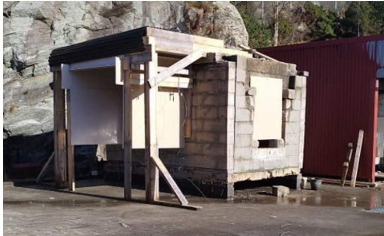
Bilde 7.2 – Konstruksjonen ferdigstilt til testbrann
