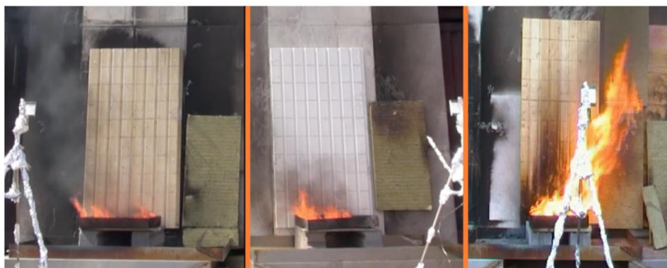
Figur 7 Bilde fra forsøket [28]. Fra venstre det er bilde av brannimpregnert KLT-overflate, brannmalt KLT-overflate og ubehandlet KLT-overflate.
