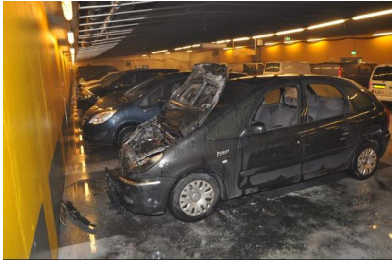
Bilde 16. Brann hvor sprinkler ble aktivert [52]
