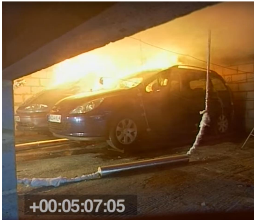
Bilde 13. BRE test (store biler) brannspredning [13]
