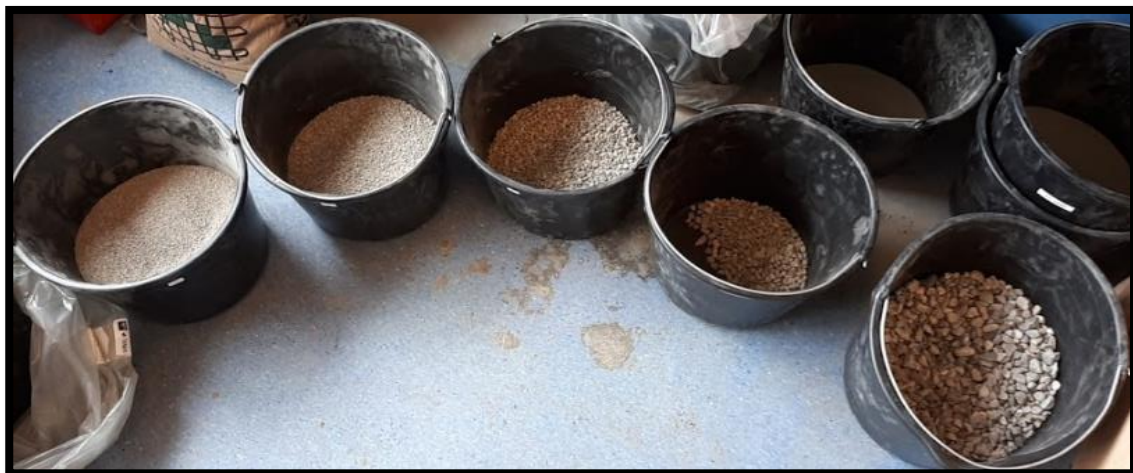
Figur 26: Viser noen fraksjoner av sand. Fra venstre: 1, 2, 4, 8 [mm] og siste bøtten til høyre viser stein 8-16 [mm].
