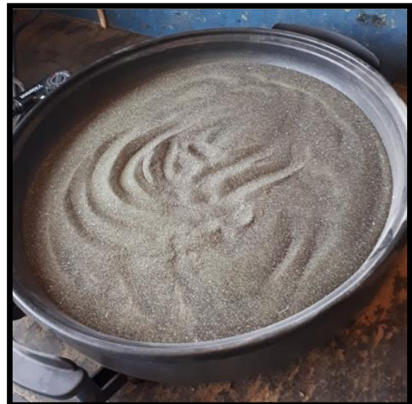
Figur 28: Viser restmasser som tørker på stekepannen.
