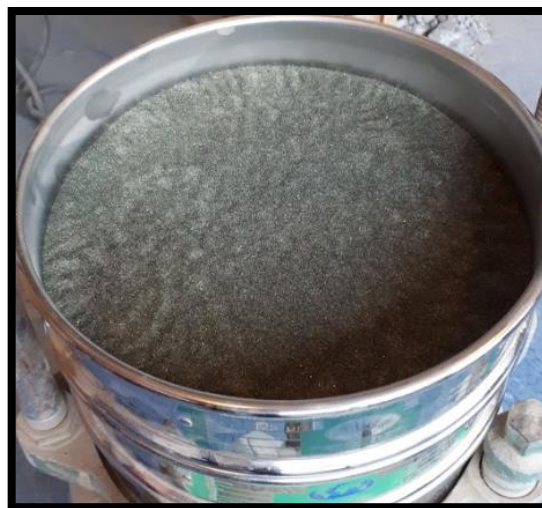
Figur 24: Viser siktet restmasse i fraksjonen 0,125 mm.
