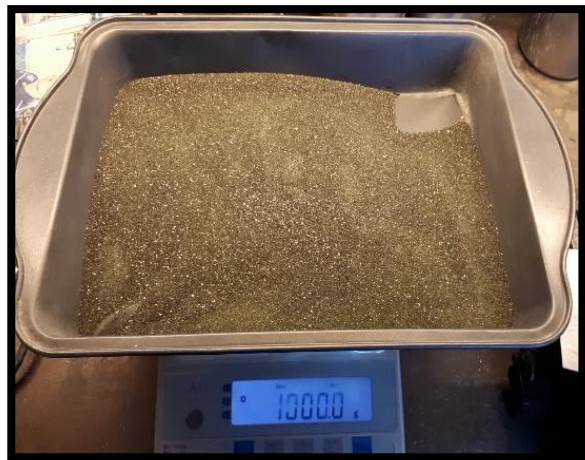
Figur 27: Viser måling av restmasser før tørking.
