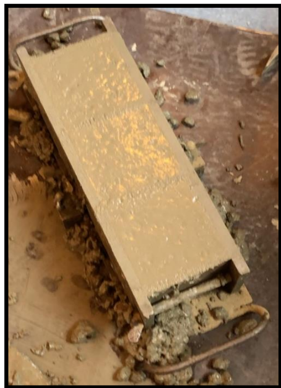
Figur 59: Viser støpeformen fylt med fersk betong.
