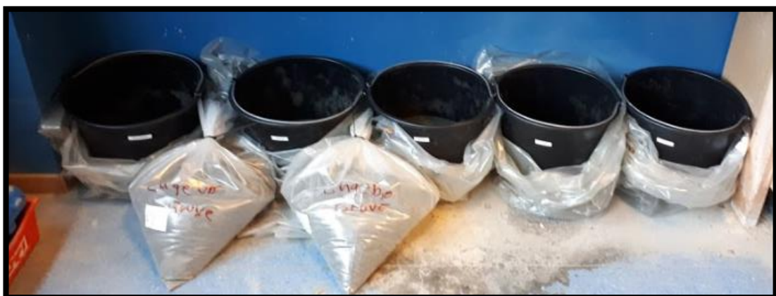
Figur 23: Viser bøtter med siktet fraksjoner av restmasse og to fulle poser. Fra venstre: Bunn, 0,063, 0,125, 0,250, 0,500 [mm].
