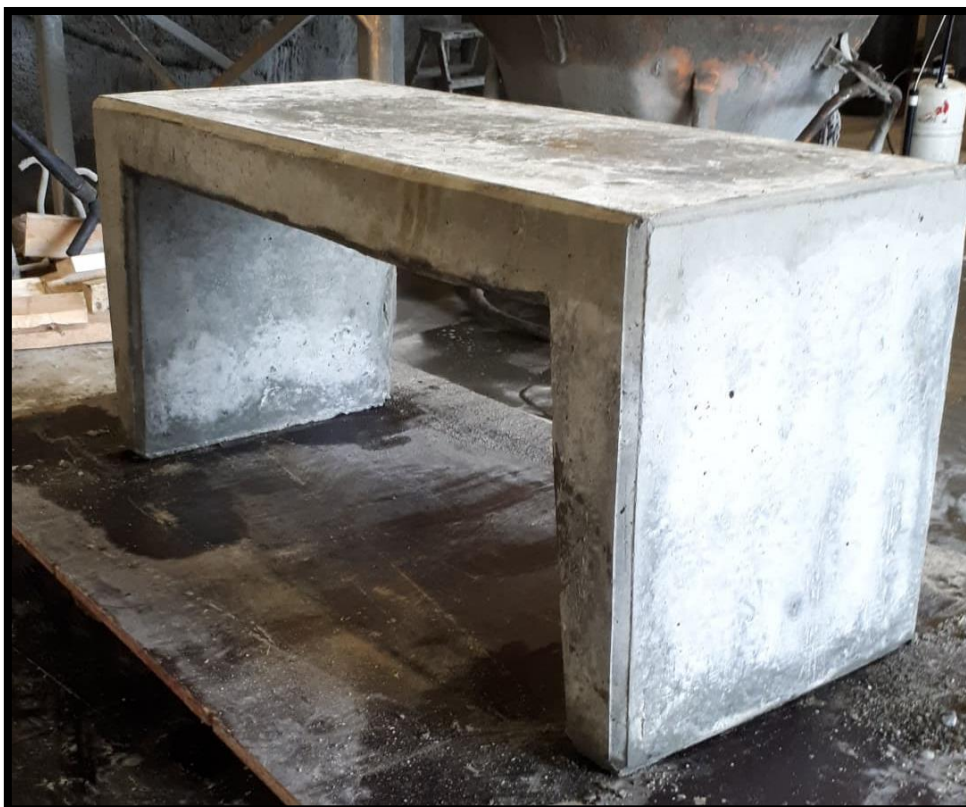
Figur 80: Viser ferdigstøpt betongbenk dagen etter støping.
