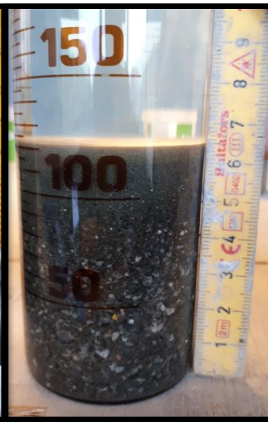
Figur 38: Viser måling av helle tilslagshøyden.
