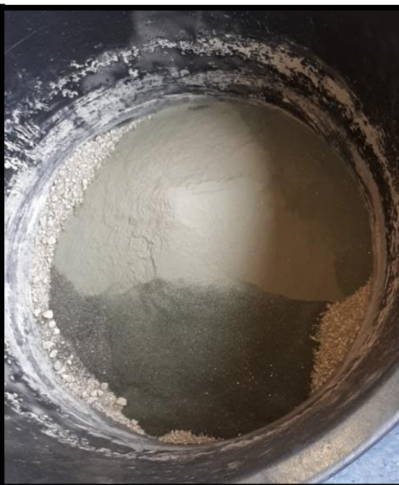
Figur 49: Viser sement oppå restmasser og sand i R1 blandingen.
