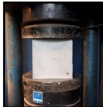
Figur 68: Viser terning plassert i trykkprøvemaskinen.
