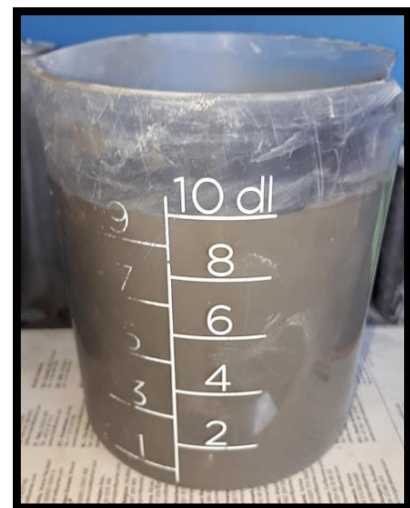
Figur 57: Viser 1 liter fersk betong i litermålet
