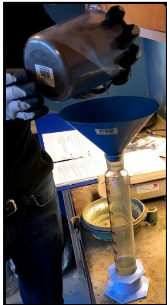
Figur 37: Viser restmasse som blir drysset i måleglasset med natronlut.
