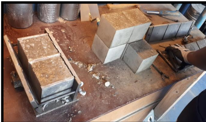
Figur 62: Viser terningene bli tatt ut av støpeformene.
