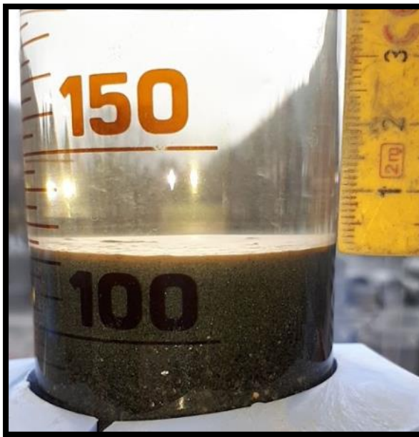
Figur 39: Viser måling av slam på toppen av tilslaget i glasset.
