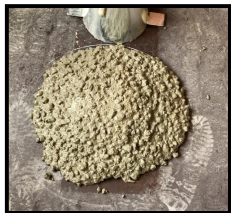
Figur 71: Viser synkutbredelsen til kontroll etter massen hadde stoppet
