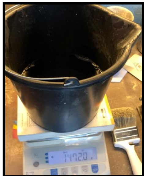
Figur 46: Viser oppmålt mengde vann for kontroll og R1.
