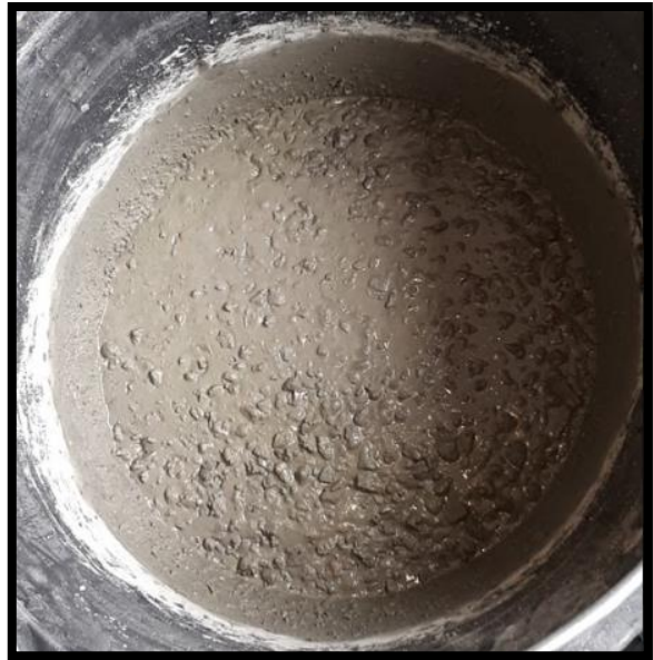
Figur 53: Viser R2 blandingen etter ønsket konsistens var oppnådd.
