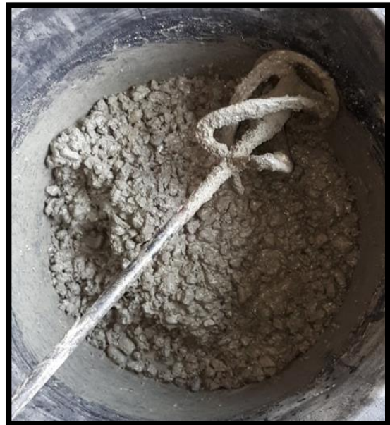
Figur 52: Viser konsitensen til R2 blandingen. Merk at denne er mindre bløt.
