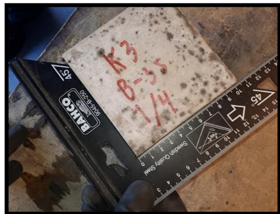
Figur 65: Viser kontroll av terningens vinkelmål
