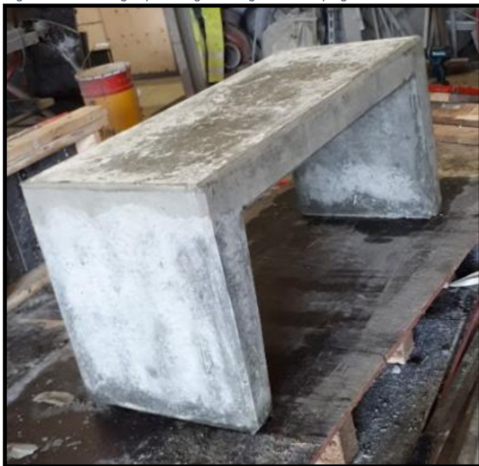
Figur 81: Viser ferdigstøpt betongbenk dagen etter støping.
