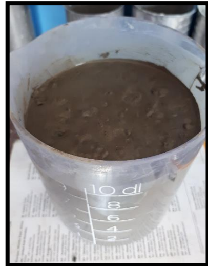
Figur 56: Viser 1 liter fersk betong i litermålet
