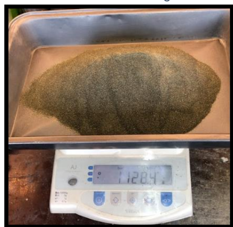
Figur 47: Viser oppmålt mengde 0,125 mm restmasse til R1 blandingen.
