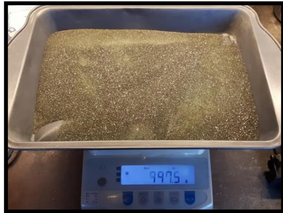
Figur 29: Viser måling av restmasse etter tørking.
