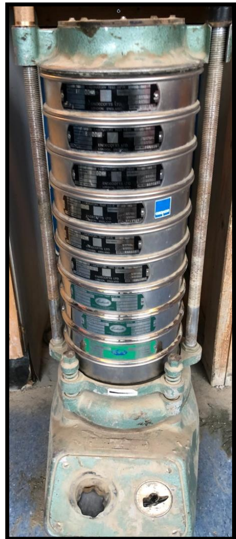
Figur 30: Viser siktemaskinen med sikteskåler. Maskinen er satt til 10 minutter.
