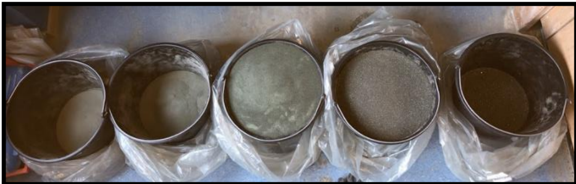
Figur 25 Viser bøtter med siktet fraksjoner av restmasse mot slutten av sikteprosessen. Fra venstre: Bunn, 0,063, 0,125, 0,250, 0,500 [mm].
