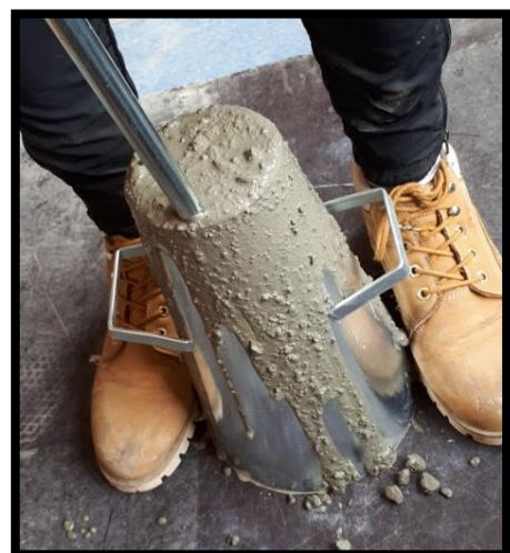
Figur 54: Viser en full kjegle som gjennomstikkes før den glettes av på toppen.
