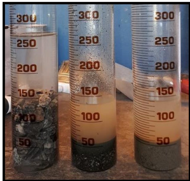
Figur 42: Viser målingene av de 3 første densitetsprøvene ved siden av hverandre. Fra venstre: Stein, R1, Sand.
