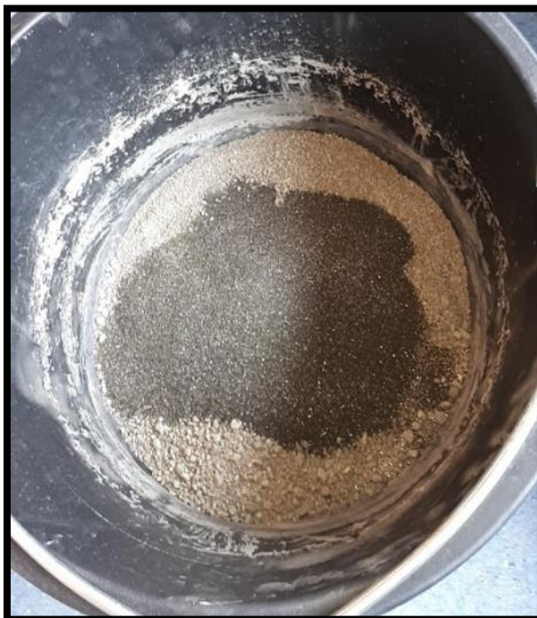
Figur 48: Viser 0,5 mm restmasse oppå sand 1-8 mm i R1 blandingen
