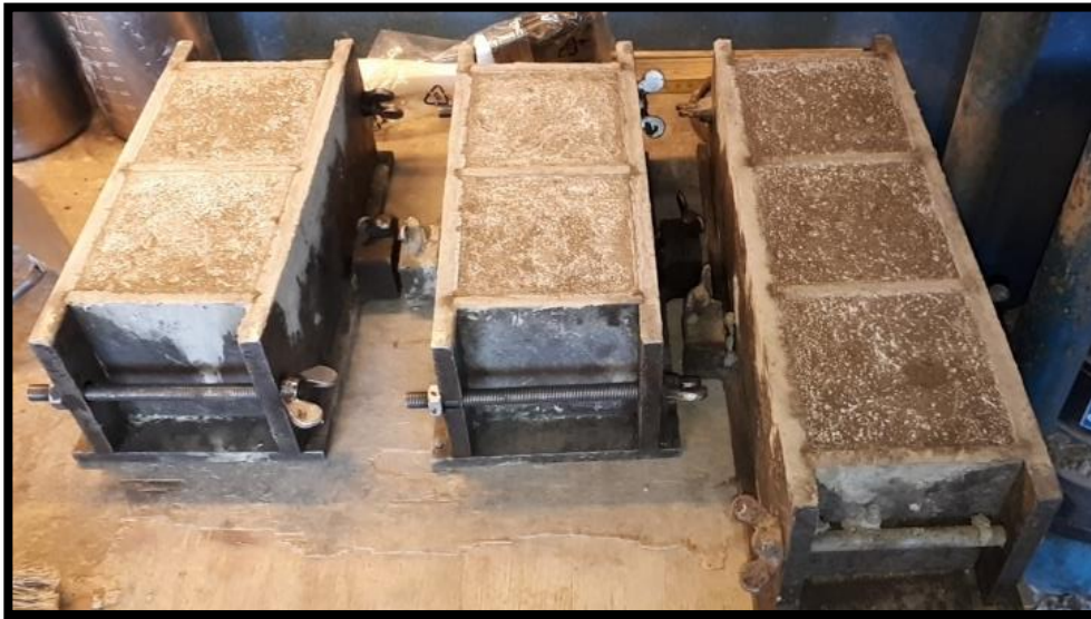
Figur 60: Viser ferdigstøpte terninger i støpeformene en dag etter støping.
