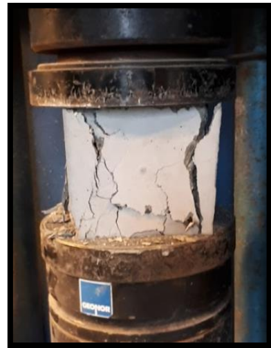
Figur 69: Viser terning som har gått til brudd.
