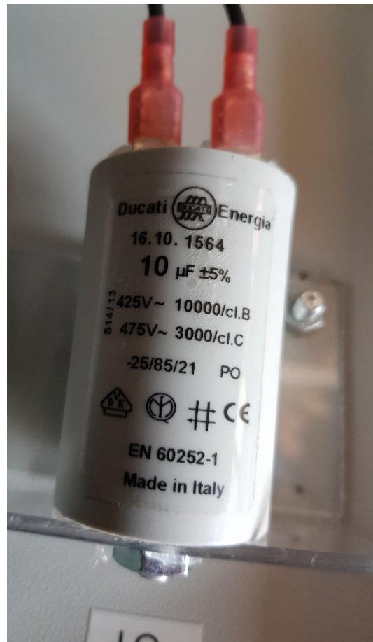
Kondensator på 10mikrofarad som brukes på generator i testmodell
