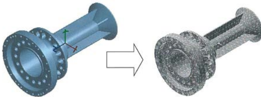
Figur 5 Kompleks geometri, påført «Mesh» som deler opp i mindre, enklere geometrier [7]
