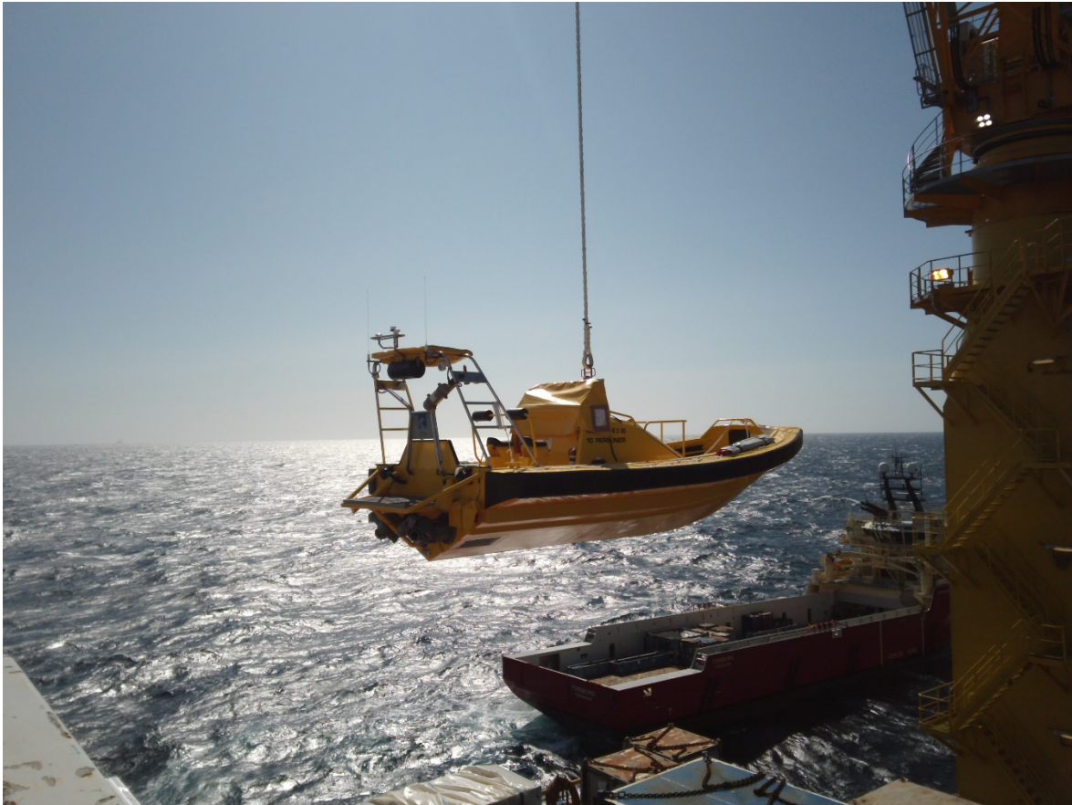
Figur 2 Mare GTC 900-2VD Løftesituasjon, båten er balansert i tyngdepunktet
