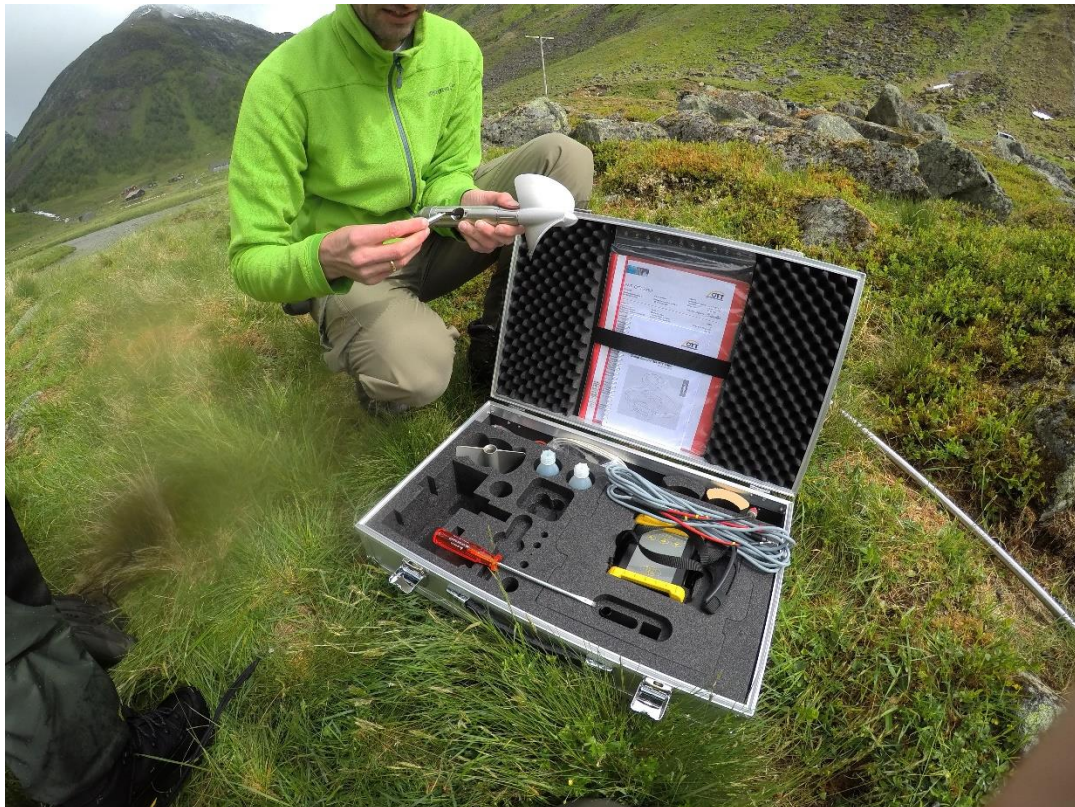
Figur 6 - Montering av flügel i felt. I kassa kan ein òg sjå OTT Z400 Signal Counter Set. Foto: Camilla Hatland.
