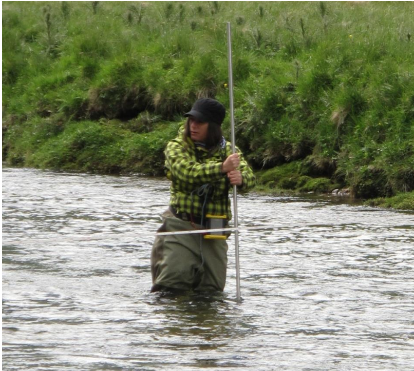
Figur 9 - Flügel i bruk av Camilla Hatland. Foto: Jacob C. Yde
