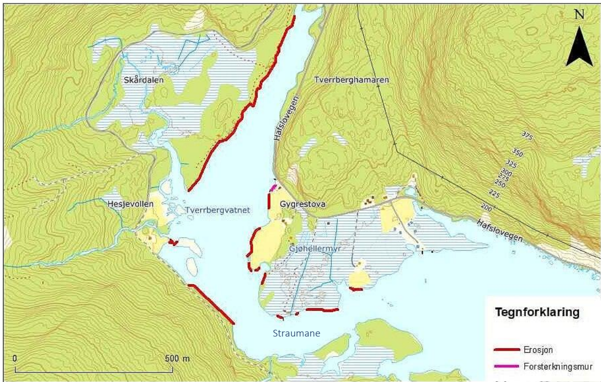
Figur 55: Kartet viser en grov kartlegging av områder med spor av erosjon påvist ved befaring. Forsterkningsmuren oppført av en grunneier er også markert. Kart produsert i ArcMap i 2019.
