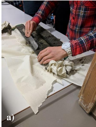
Figur 22a og b: a) Overflaten på kjernen blir gjort glatt ved å dra sparkelkniven parallelt med lagdelingen. b) Bildet viser en av kjernene etter at overflaten har blitt glatt, og lagdeling og farge er kommet frem. Foto: Asbjørn Mong, 2018.
