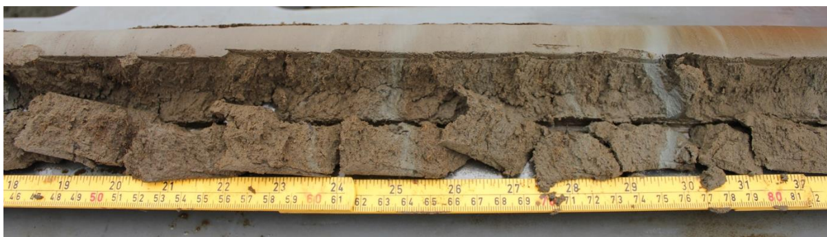
Figur 22. Enhet 3a i P15 1000-1100 cm etter at vi har «knekket opp» prøven. Her sees tre tydelige siltlamina, ved 1060 cm, 1064 cm og 1076 cm. Det nederste er tydeligst og skiller seg veldig ut fra de gytjerike sedimentene. Mellom de lyse siltlaminaene ligger lagdelt oliven-gråbrun siltig, sandig gytje med planterester. (Foto: Sondre Svevad)
