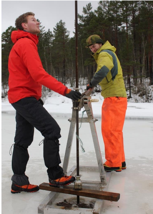
Figur 9. Oppjekking av russerboret. Å bore fra isen er enklere og mer stabilt enn fra flåte. De beste forholdene er trygg is, varmegrader i lufta på dagtid og ikke for mye overvann. Isen var ca. 35 cm tykk og vi hadde plussgrader under hele feltarbeidet. (Foto: Stein Bondevik)
