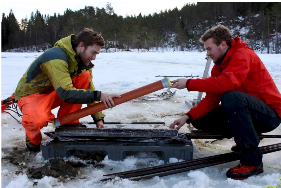
Figur 10. Fra Litletjørna. Her pakkes en prøve fra 100 mm russerbor i plastfolie og puttes i et kløvd plastrør med endelukk. (Foto: Stein Bondevik)
