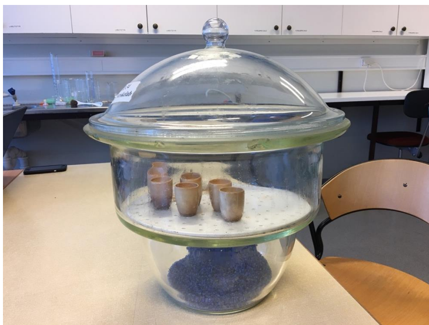
Figur 11. Bildet viser brente digler som avkjøles i en eksikator. Eksikatoren sørger for at prøvene avkjøles lufttett, slik at de ikke tilføres fuktighet. (Foto: Sondre Svevad)
