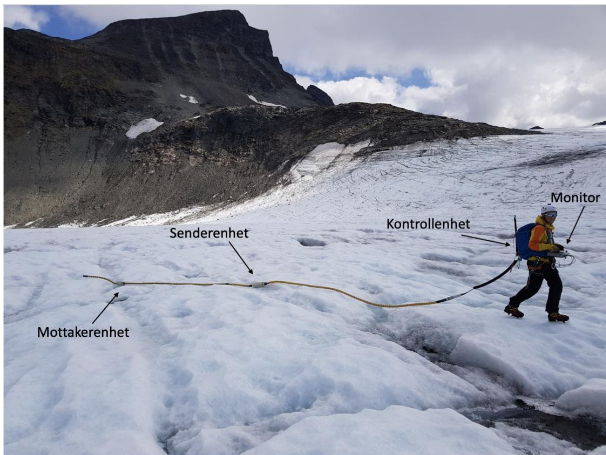
Figur 9: Georadarens oppbygging. Monitor, kontrollenhet, senderenhet og mottakerenhet er illustrert.
