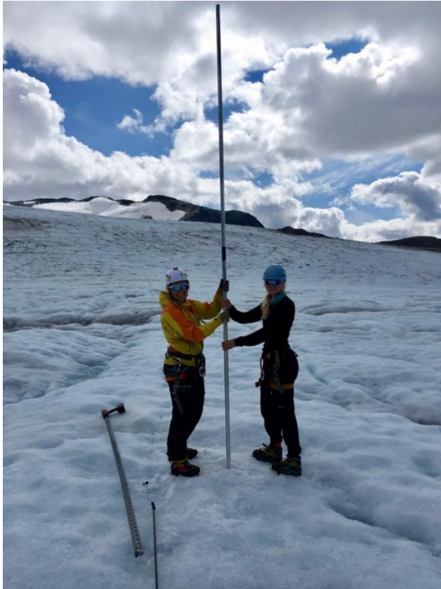
Figur 15: Ut plassering av massebalansestake på Leirbreen 14.08.19. 2 meter av staken ble plassert ned i isen.
