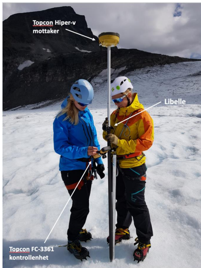
Figur 19: DGPS måling ble gjennomført på Leirbreen den 14.08.2018 og 01.01.18. DGPSen er bestående av en mottaker, en kontrollenhet og libelle.
