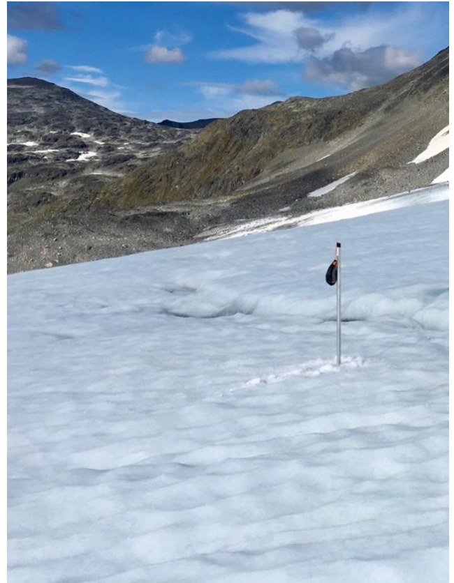
Figur 16: Massebalansestaken etter plassering. En meter ble stående igjen over breoverflaten.
