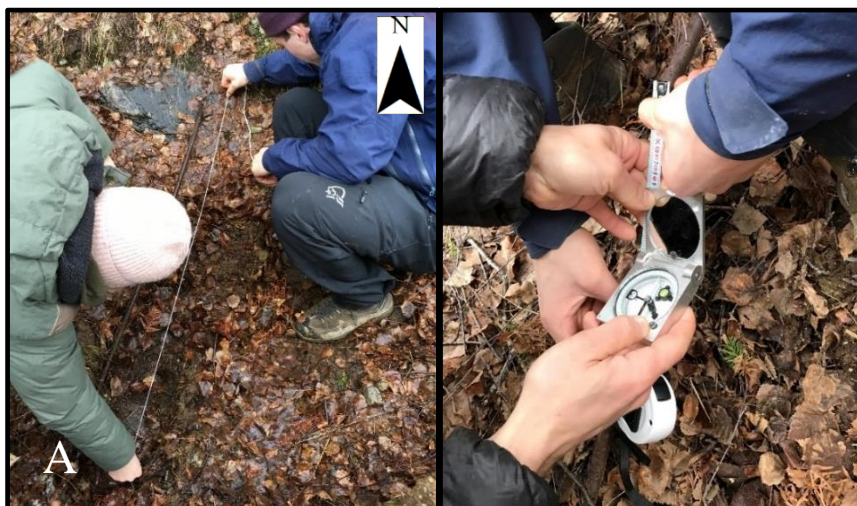
Figur 14: (A) Metode for avstandsmåling på boltepar fra 1974. (B) Metode for måling av retning og avstand mellom boltepar fra 1970.
