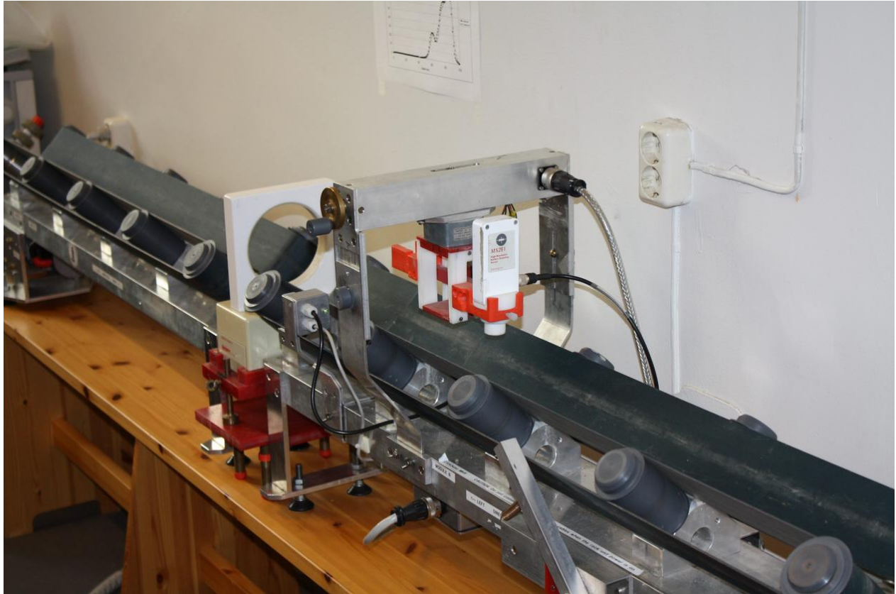
Figur 10 Coresusc MkIII med en MS2E sensor. Hentet fra UiB sin hjemmeside
