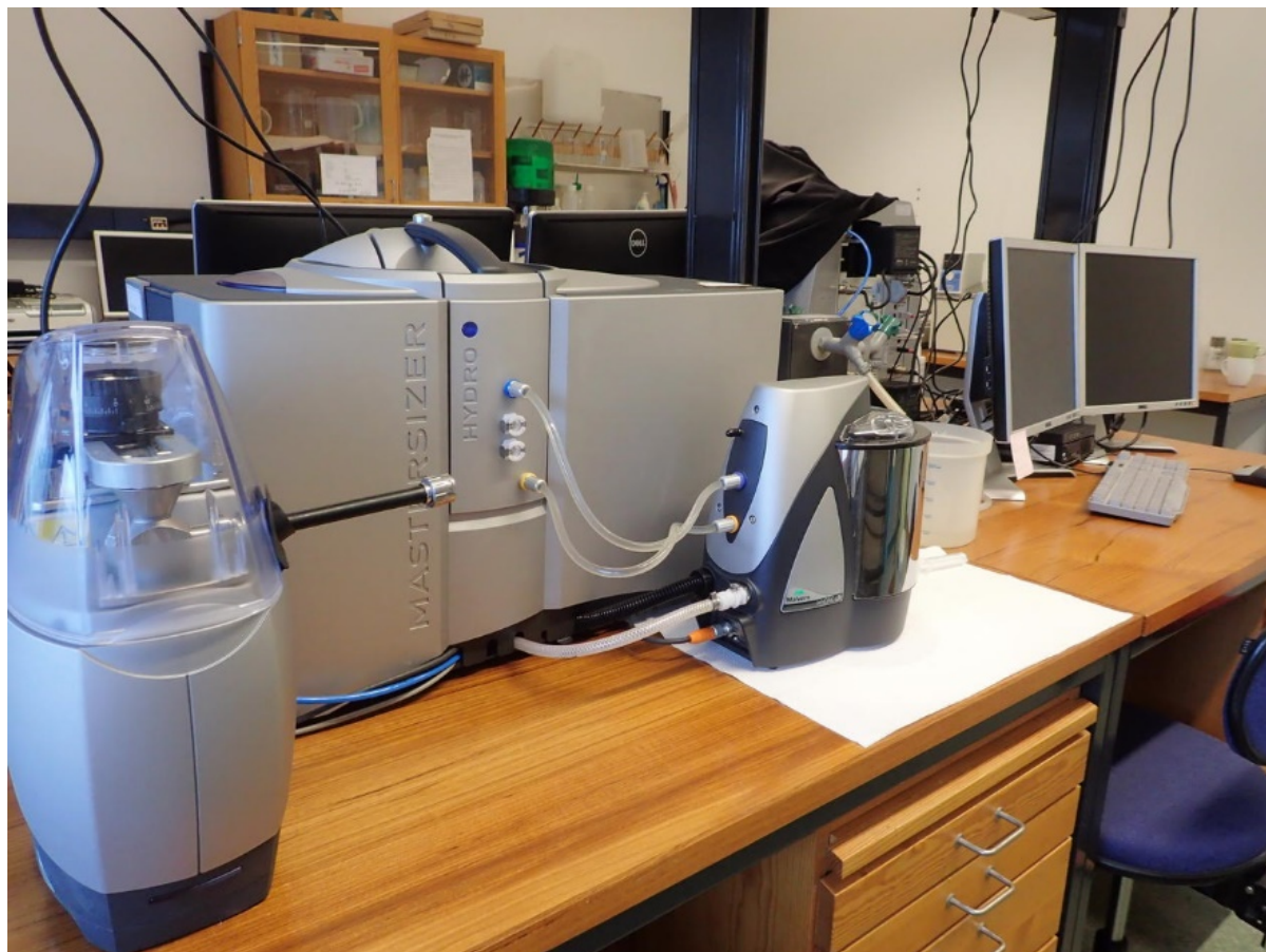
Figur 13 Mastersizer 3000. Bilde hentet fra UiB sin hjemmeside
