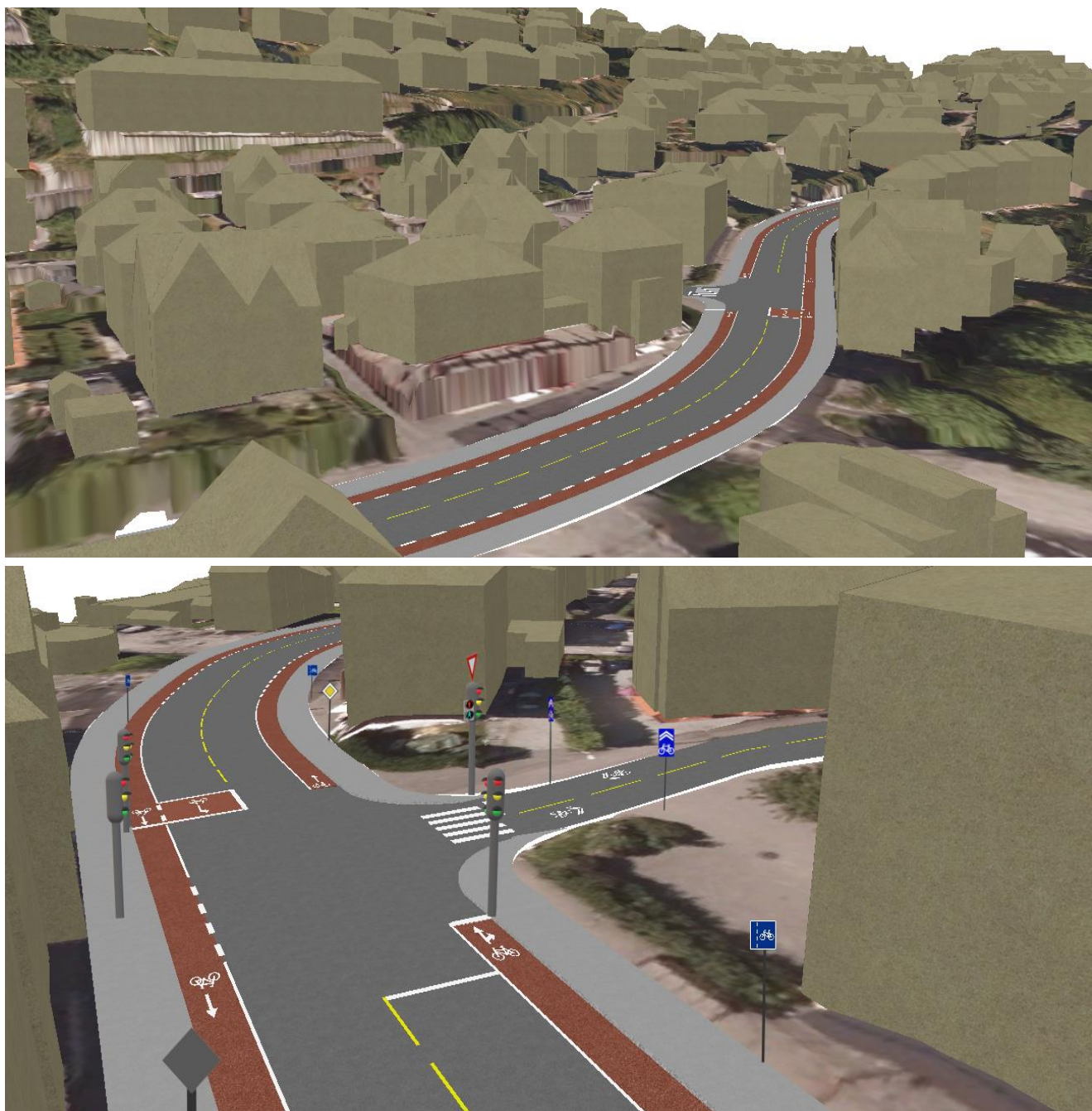
Figur 58 - Den anbefalte løsningen illustrert i Vognstølen-krysset [Foto: Skjermdump i Novapoint, redigert i Paint 3D].
