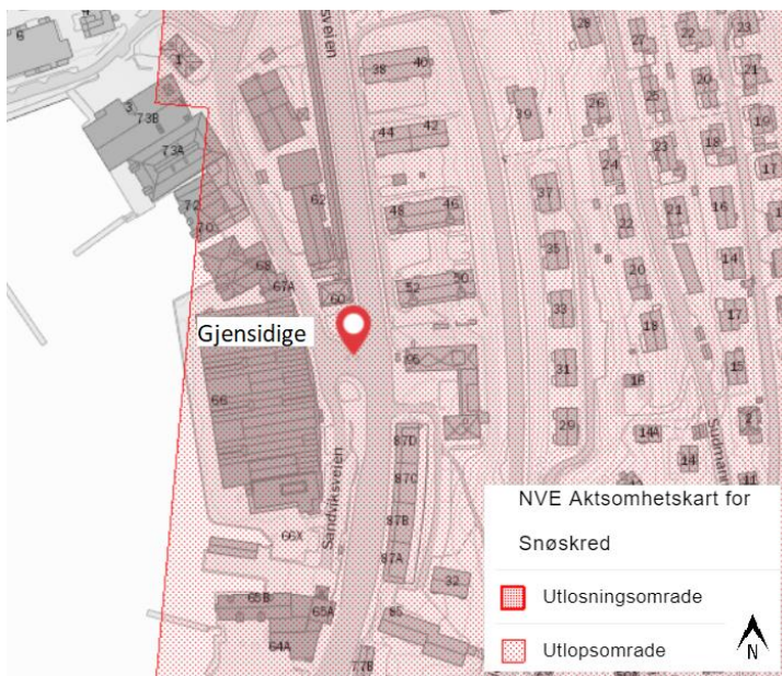
Figur 73 - Kryssområdet ved Gjensidige ligger innenfor utløpsområdet for snøskred.
