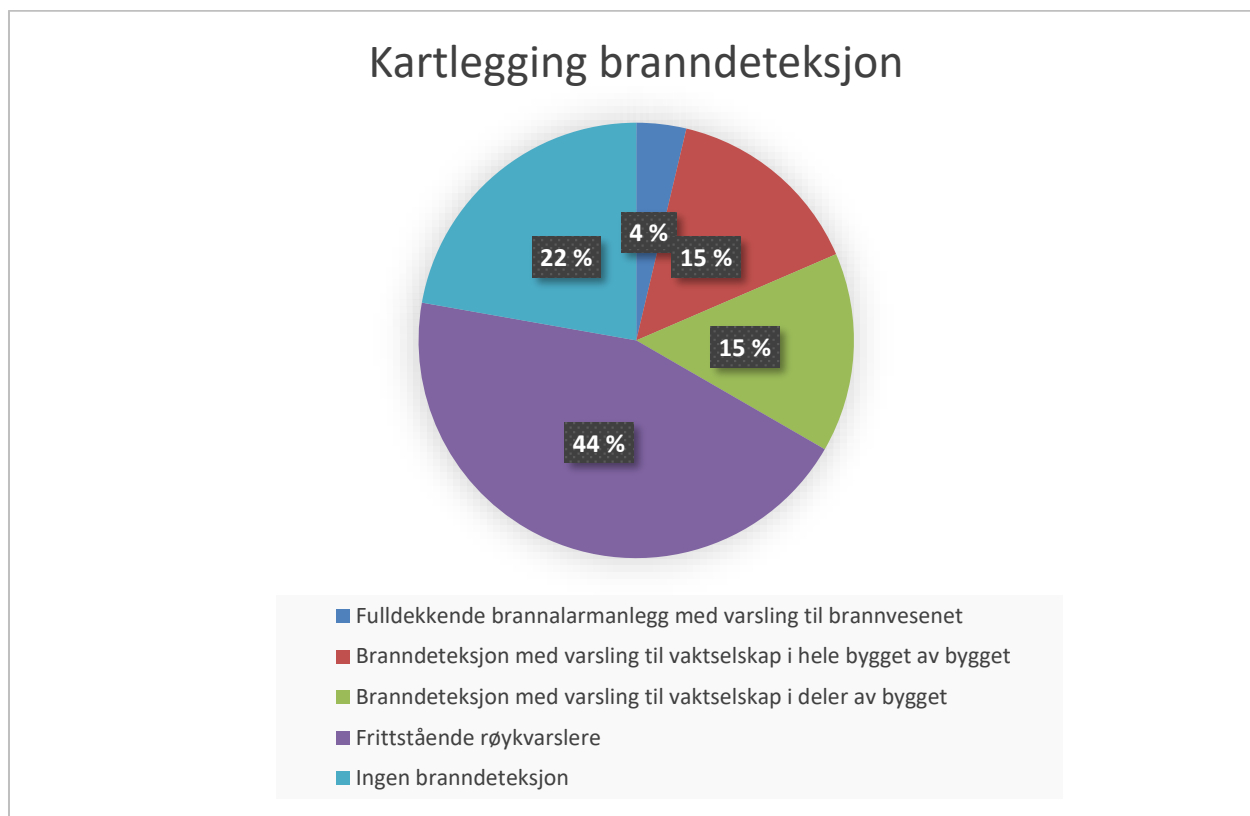
Figur 36 - Kartlegging branndeteksjon eksisterende bebyggelse
