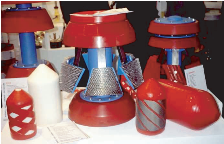
Figur 25: Eksempler på forskjellige typer av pluggere og pigger [15].
