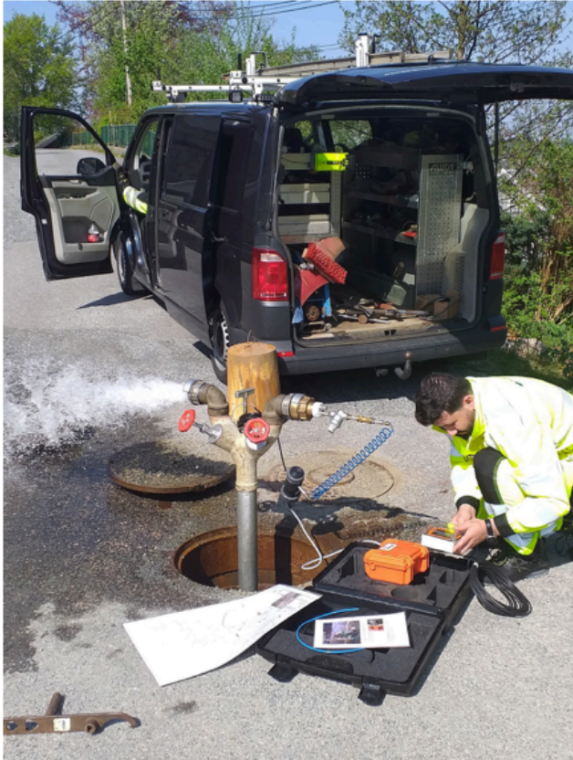
Figur 21: Turbiditetsmåling ved utspylingspunkt. Foto: Hassan Botan. Illustrasjon: Bergen vann.
