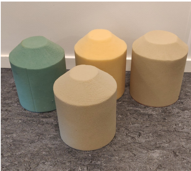
Figur 24: Eksempler på myke pluggen hos Bergen Vann. Foto: Kassem Ali Al-Sheikh
