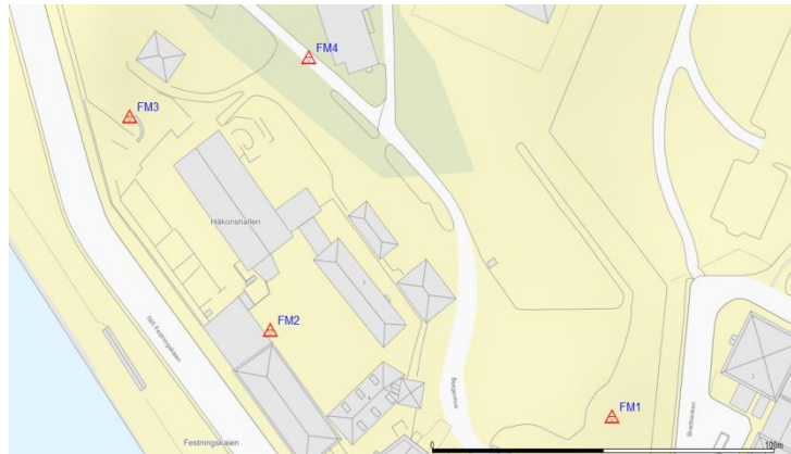
Figur 2: Fastmerker FM1-FM4 etter vektorprosessering vist i Gemini Oppmåling
