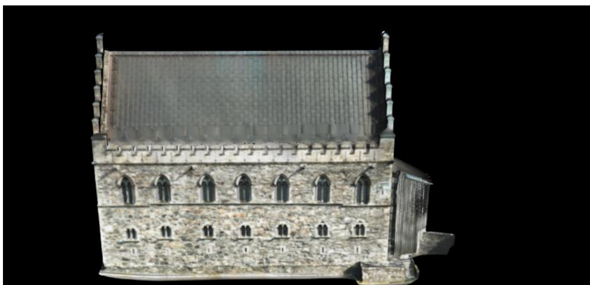
Figur 14: 3D-modellen vi sitter igjen med etter å ha arbeidet i Leica Cyclone, CloudCompare og Cinema 4D. I modellen finnes 1 100 000 triangler og 562 000 vertexer. Se vedlegg 11.2.1.5 for video av modellen
