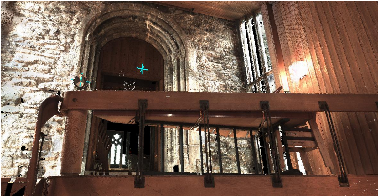
Figur 22: Innsiden av trappeoppgangen etter registrering i Cyclone. Her fremvist med tekstur dannet ved hjelp av Leica P20s eget kamera.
