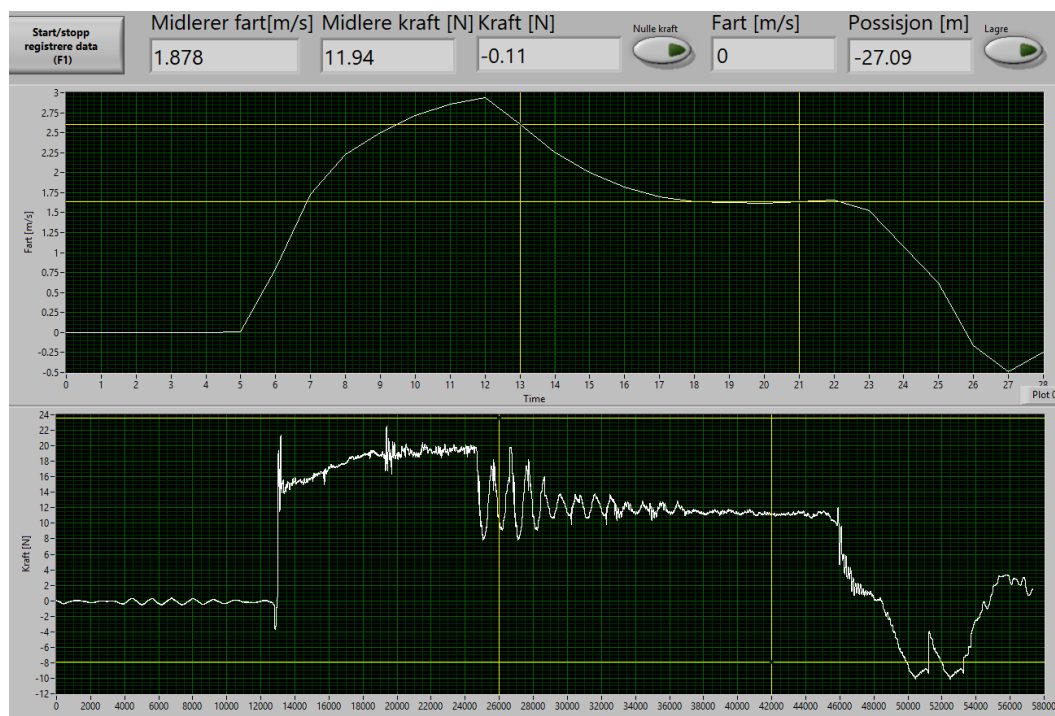
Figur 26: Test 127. Målingene er tatt over samme tidsintervall som test 88 for sammenligning av fart og motstandskraft
