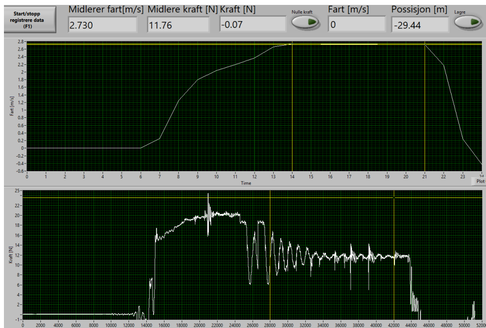
Figur 25: Test nr. 88, markert fet skrift i Tabell 7. Hastighet (øverst) og motstandskraft målt samtidig. Eksponentiell motstandsdempning ved jevn hastighetsgraf
