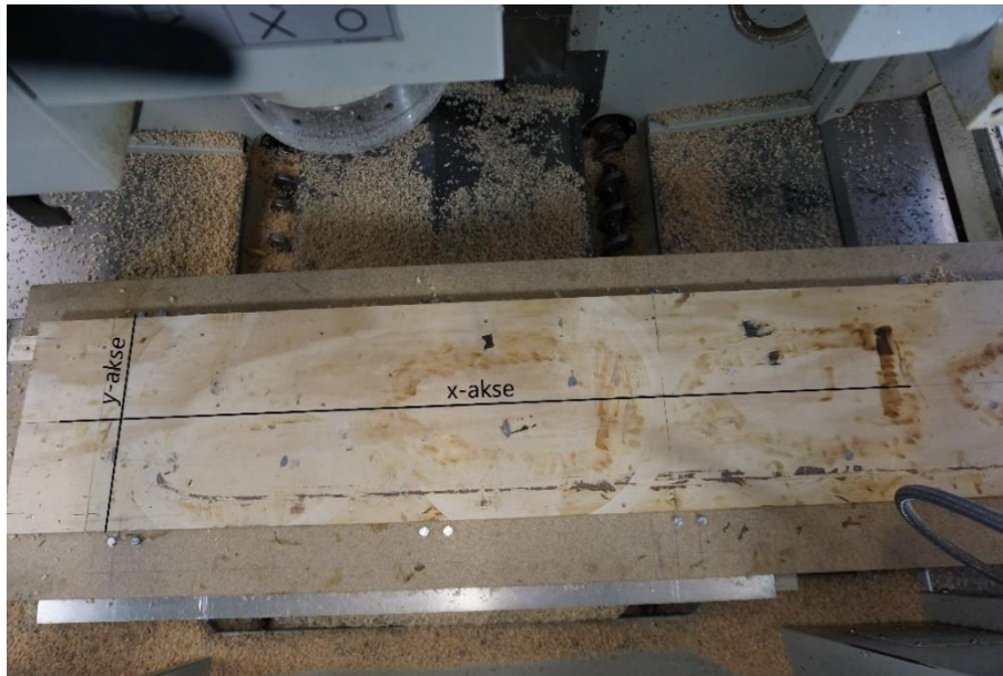
Figur 3: Plate med tilhørende koordinatsystem.
