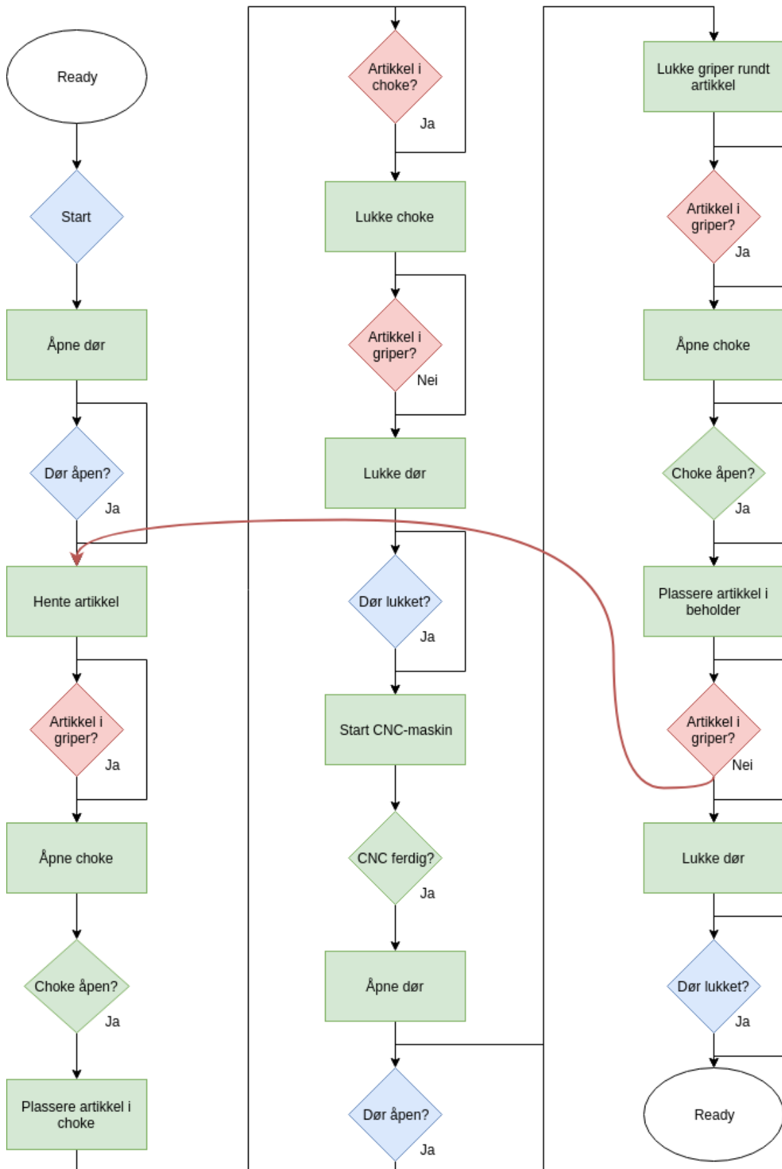
Figur 24 Flytskjema for robotens prosess. Bokser i grønn indikerer enkel implementering til styringsenheten. Blå bokser indikerer ekstra komponenter som enkelt kan legges til. Røde bokser indikerer at styringsenheten ikke klarer det fra fabrikkstandard.
