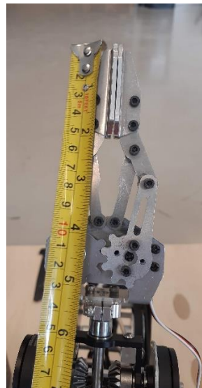
Figur 20 Når griperen er helt lukket så er den 145mm lang
