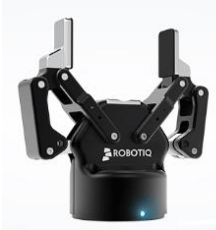
Figur 28 Adaptiv griper fra Robotiq, laget for Universal Robots colabrative roboter. De sølvfargede «fingrene» kan byttes ut. Hentet fra Universal Robots hjemmeside.
