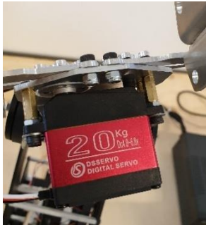
Figur 11 Servo motor. Blir brukt til å drive griperen
