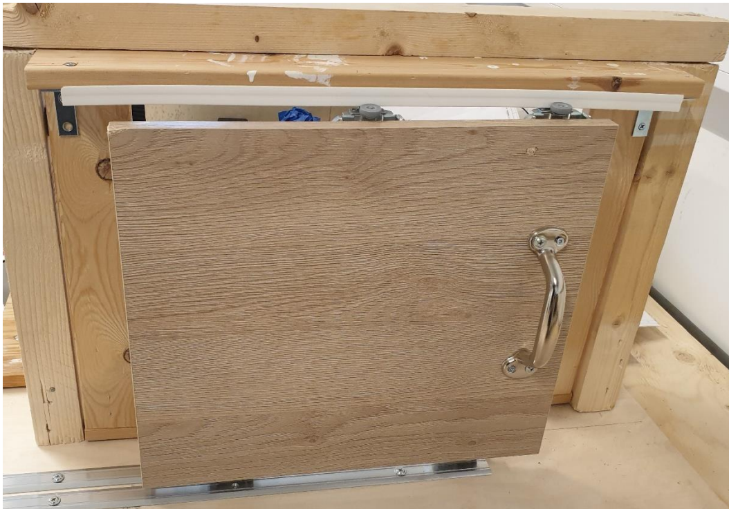
Figur 22 Nedskalert modell av skyvedøren. På bildet vises: Skyvedør, Håndtak, overgangslister for gulv, skillevegg for kanaler, hjul til garderobeskap, festebreketter, diverse tremateriale og bunnplate
