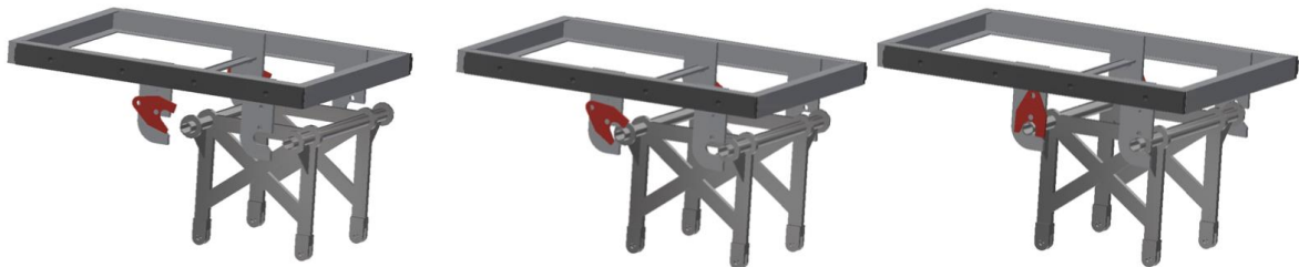
Figur 6-18 Hurtigfestemekanisme for ROV-oppheng
