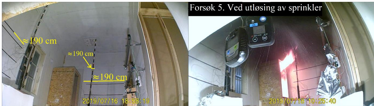
Bilde. 6. Brannscenario A: Forsøk 5 - Fri sikt under røyklag ved utløsning av sprinkler
