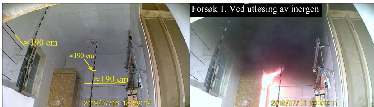
Bilde. 5. Brannscenario A: Forsøk 1 - Fri sikt under røyklag ved utløsning av Inergen.
