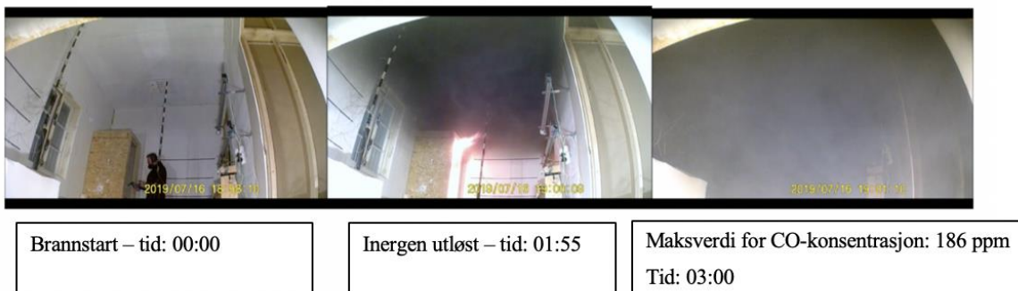
Figur 40 Scenario A: skjermbilder fra forsøk 1 og 5 ved brannstart, utløst anlegg og høyest målte CO-konsentrasjon.
