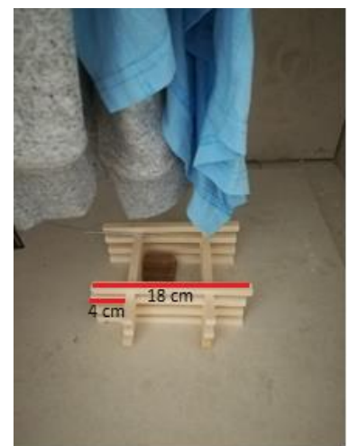
Bilde. 4. Oppsett for tennkilde brukt i forsøkene
