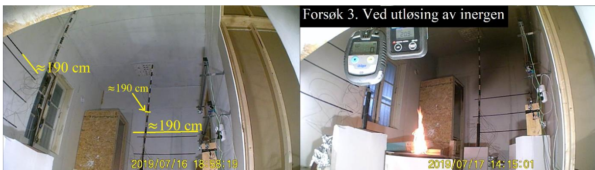
Bilde. 7. Brannscenario B: Forsøk 3 - Fri sikt under røyklag ved utløsning av Inergen.
