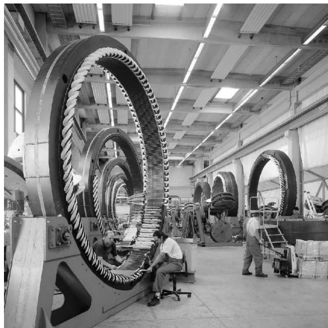
Figur 19 - Produksjon av multi-polet synkrongeneratorer av Enercon
