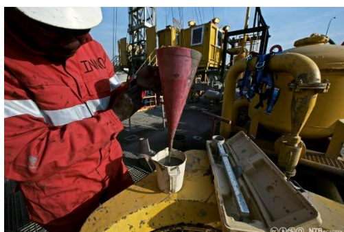
Figur 37 - Viskositetssjekk for borevæske utført for hånd hentet fra ndla.no [19]
