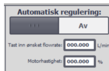
Figur 45 - HMI, Automatisk regulering
