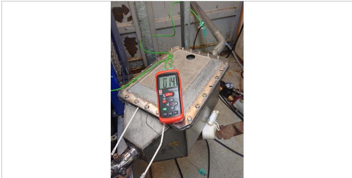
Figur 18: Bilde av temperaturmåling og temperaturfølere (1, 5, 6)
