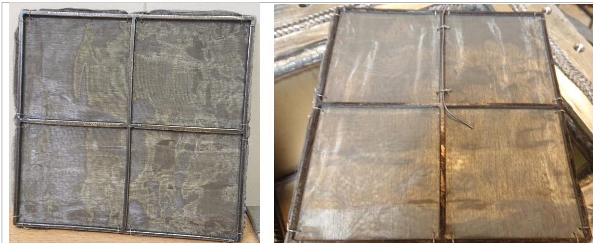
Figur 20: Bilde av katalysatornett før og etter forsøk. (Før bruk til venstre, etter bruk til høyre)
