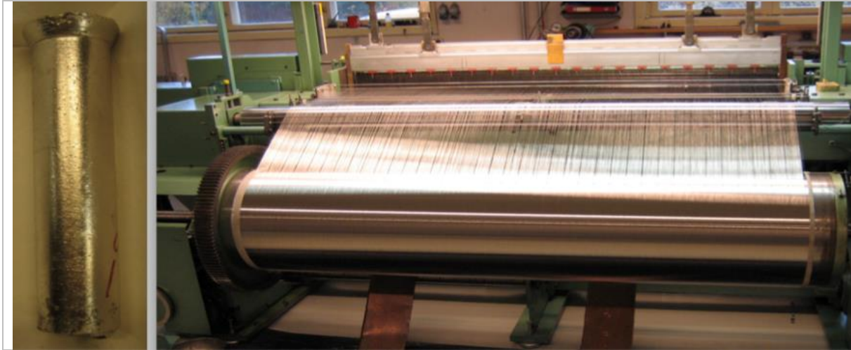
Figur 19: Til venstre vises en palladium bolt og til høyre vises et nett lagd av tynne palladium tråder [3].
