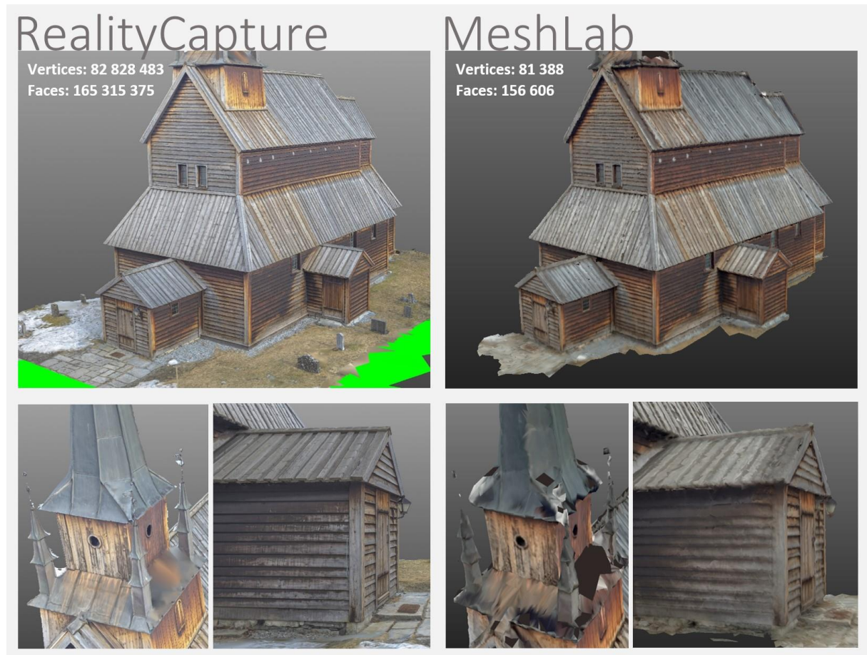
Figur 43: Side om side visning av ukomprimert og kraftig forenklet polygonmodell
