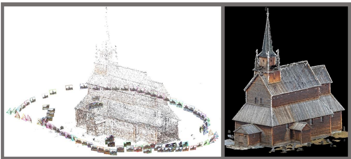
Figur 32: Rekonstruksjon av "sparse cloud" (venstre) og "dense cloud"(høyre).
