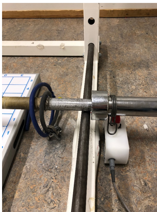
Bilde 4: Viser enkoderen og hvordan de elastiske båndene var ankret til gulvet.
