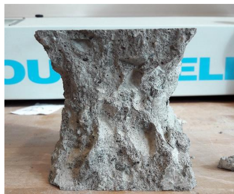
Figur 5-10: Bruddform som en epleskrott. Her en terning av Ref2.B30
