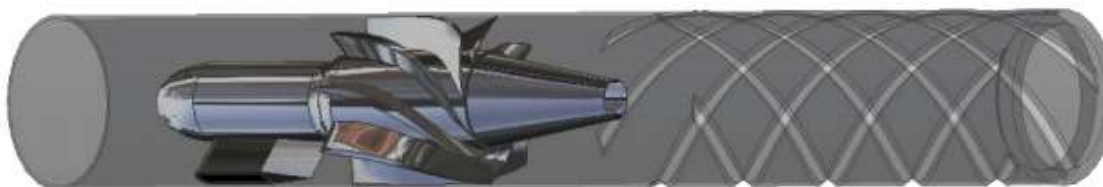
Figur 28 - ConSept DC80 syklon dråpeutskiller (Schlumberger)
