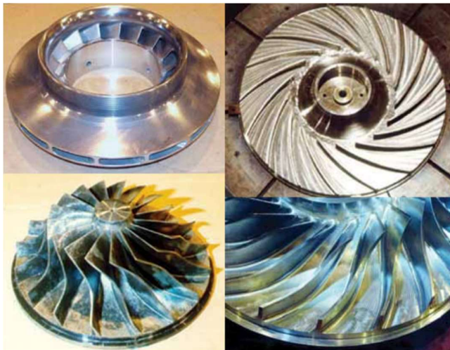
Figur 16 – Forskjellige typer impellere (Sorokes, 2013)
