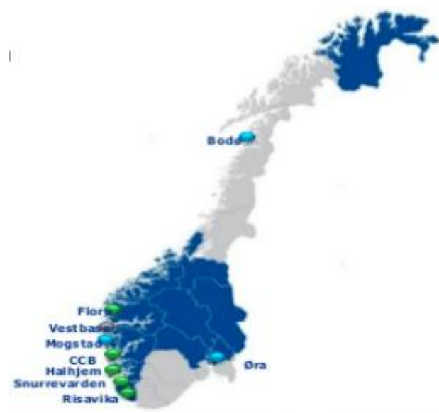
Figur 7.3. Oversiktsbilde bunkringsstasjoner LNG (DNV GL, 2014).
