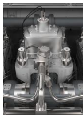
Figur 7. 2. Dual-fuel innsprøyting (Wärtsilä, u.d.). (upublisert)
