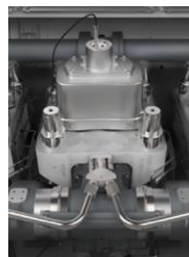
Figur 7. 1. Diesel innsprøyting (Wärtsilä, u.d.). (upublisert)
