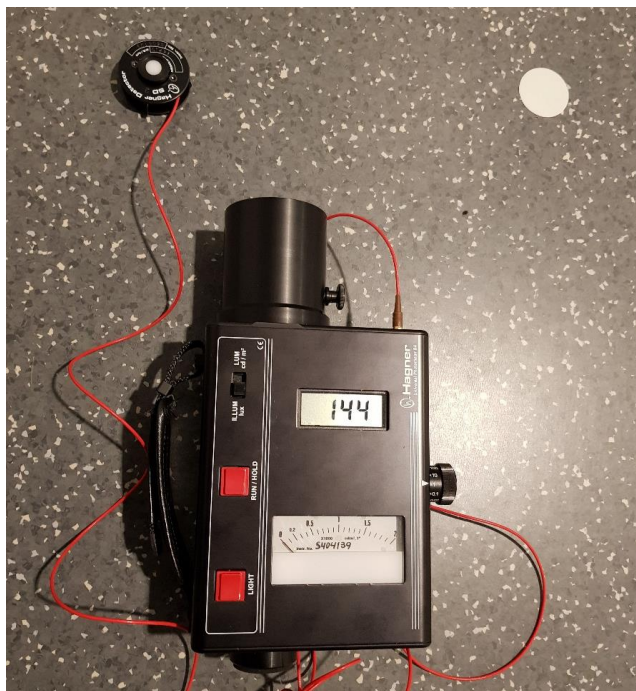
Figur 6 - Fotometer Hagner S4. Bilde fra lysmålinger ved Voss Gymnas [65]
