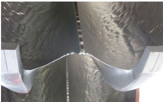
Figur 11: Viser skader frå småpartiklar, f.eks. sand, i vatnet som sliter ned metallet. [14]
