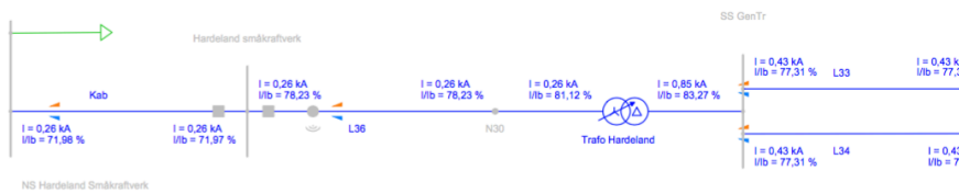
Figur 33: Den blå fargen viser belastninga på kabel som er mellom 50-100 %. Får man raud farge vil kabel være overbelasta. Grøn farge betyr at det er under 50 %.
