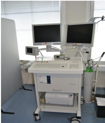
Bilde 3.3: Utstyr for gjennomføring av ergospirometriske målinger: CS – 200 Ergo-Spiro med Schiller Ganshorn Medizin Electronic Powercube.
