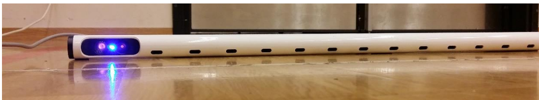
Figur 4: IR-mat (type IR870_640x427) med infrarødt lys som måler kontakttid i hopp og steg.
