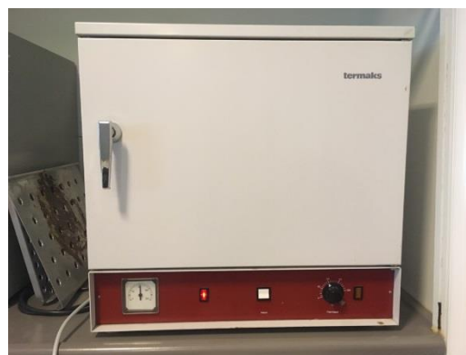
Figur 19: TERMAKS tørkeovn som ble brukt til tørking av glassfiberfilter
