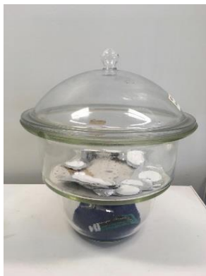
Figur 18: Eksikator for oppbevaring av glassfiberfilter
