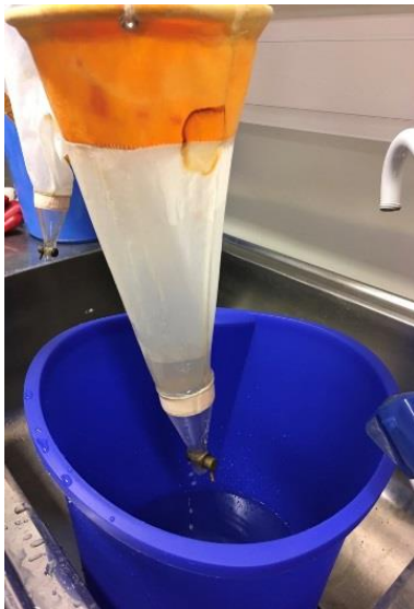
Figur 8: Filtrering av vekstmedium gjennom filter med maskestørrelse 25 \mu m
