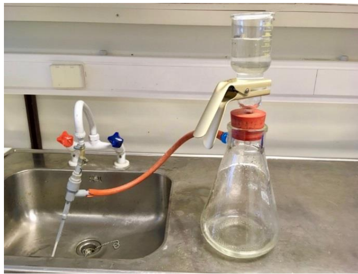
Figur 9: Filtrering av vekstmedium gjennom Millipore filtrerings-oppsett
