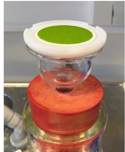
Figur 17: Filtrering av alger gjennom glassfiberfilter
