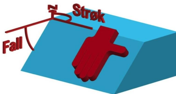
Figur 13 Høyrehåndsregelen ved strøk- og fallmåling. Fallretningen blir retningen til den bratteste fallvinkelen. Tommelen på høyre hånd bestemmer strøk.
