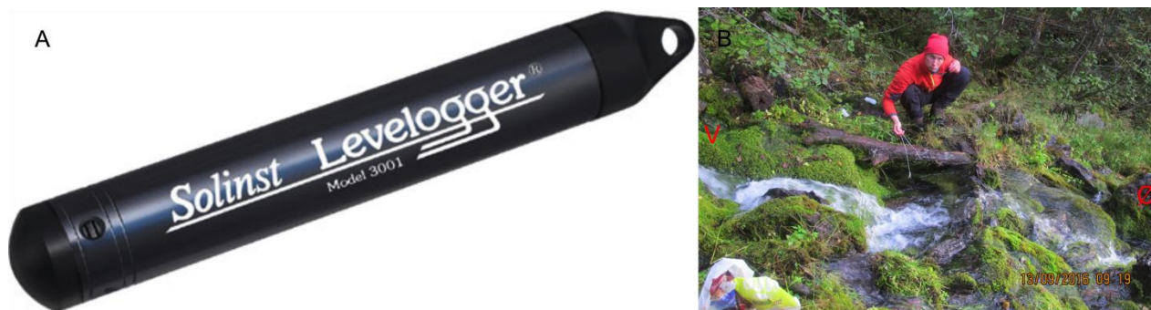
Figur 16 A; «Diver» som måler trykk og temperatur. Hentet fra Solinst (2017). B; Oppsett av «diver» i K2
