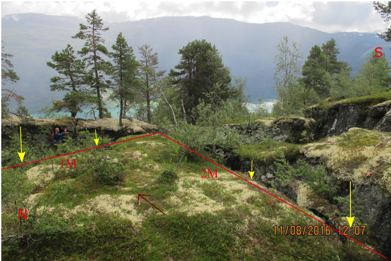
Figur 27 Blokk avgrenset med 1M og 2M-sprekker. Rød pil indikerer blokkens antatte horisontale bevegelse, gule piler indikerer vertikal bevegelse i relasjon til tilstøtende blokker.
