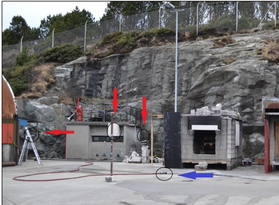
Bilde 10 - Plassering av kameraer og brannslange
