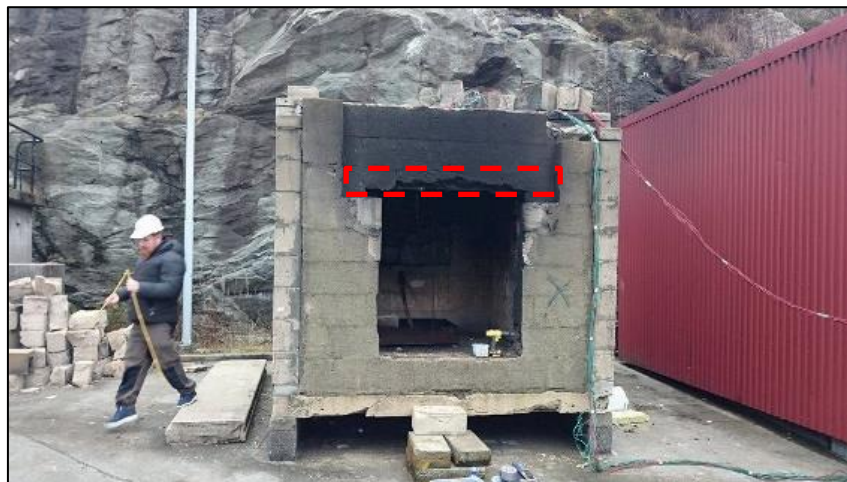
Bilde 1 - «Testrom», striplet rute på bilde tenkes tildekket for å hindre større røykevakuering ut fremside
