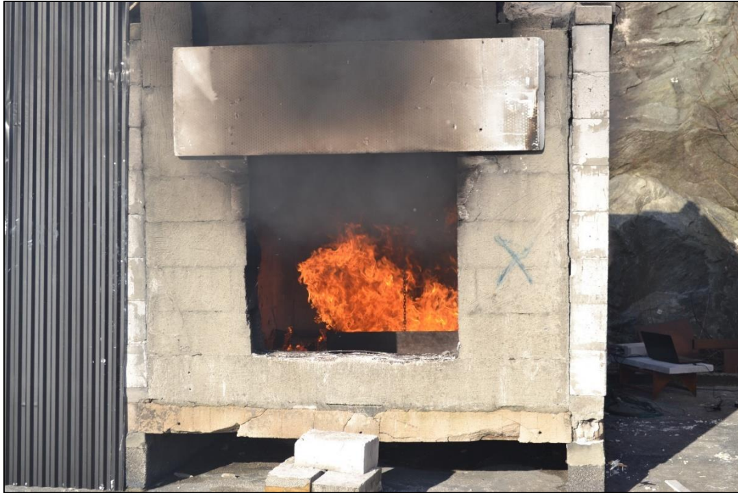
Bilde 3 - Tildekning av frontåpning med gips, steinull og skamotecplate
