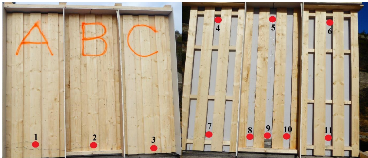
Bilde 5.6 Test 3 – Plassering av termoelementer
