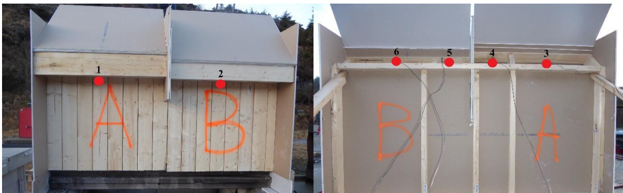
Bilde 5.4 Test 2 – Plassering av termoelementer
