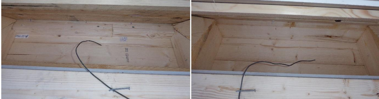
Bilde 5.3 Test 2 – Plassering av termoelementer
