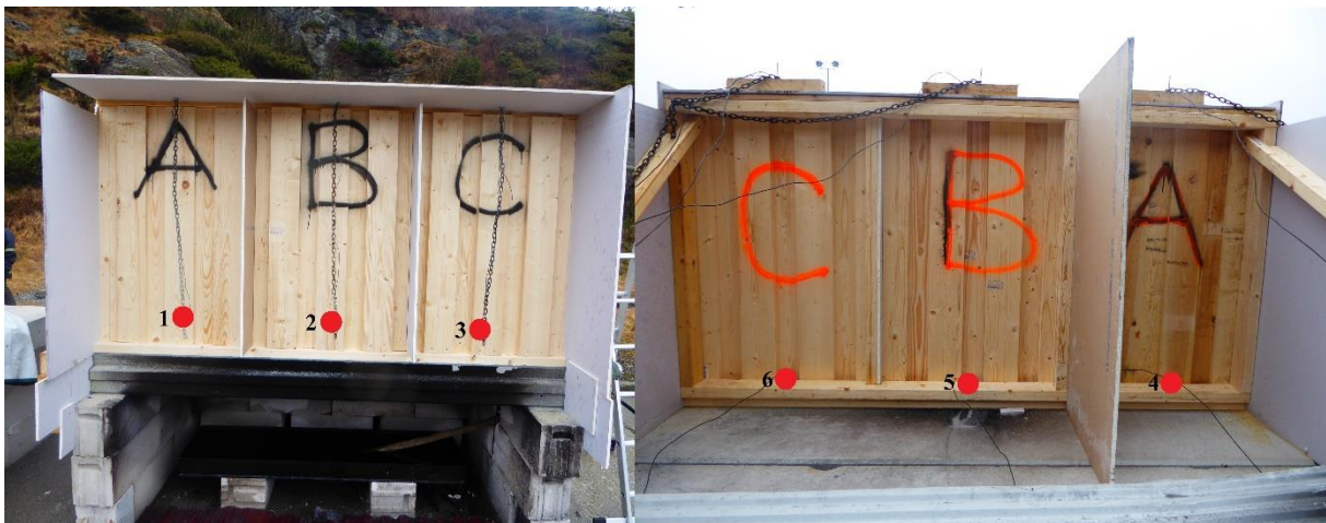
Bilde 5.1 Test 1 – Plassering av termoelementer
