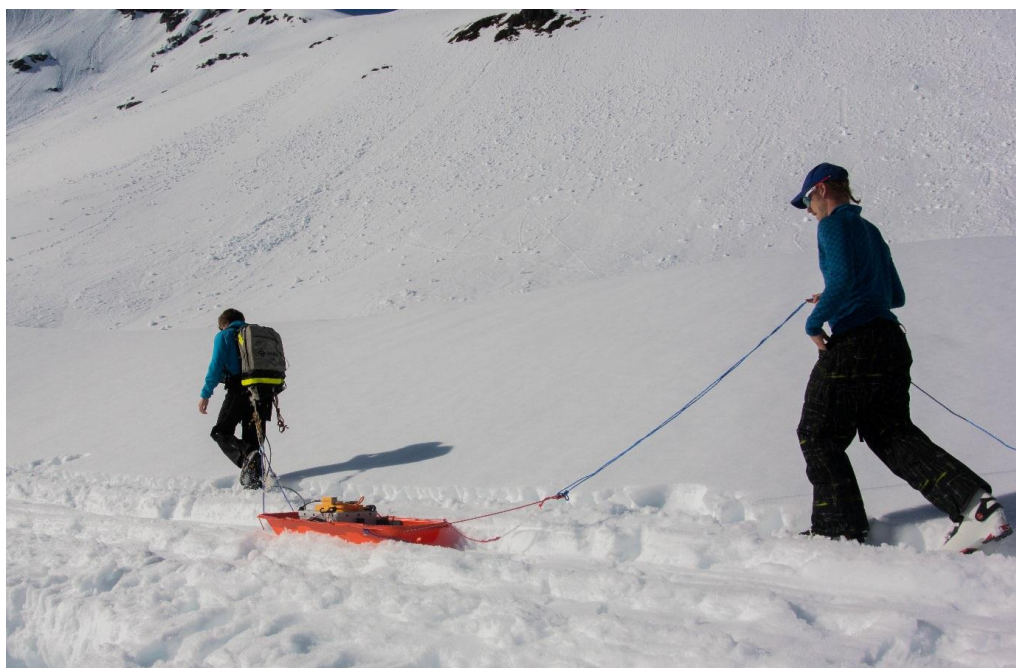
Figur 20: Oversikt over utførelse av eksperiment i Frudalen. Radaren blir dratt i spor nr 2. En person drar radaren, og den andre sikrer at den holder seg i sporet med hjelp av tau festet bak i pulken.
