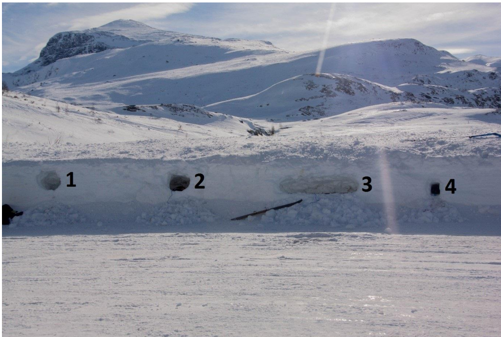
Figur 19: Figuren viser brøytekanten som ble brukt i eksperimentet på Turtagrø med nummererte hull. Forsøk 1 og 2 trengte 4 hull. I tillegg ble det gravd to ekstra hull for å utføre de resterende forsøkene.
