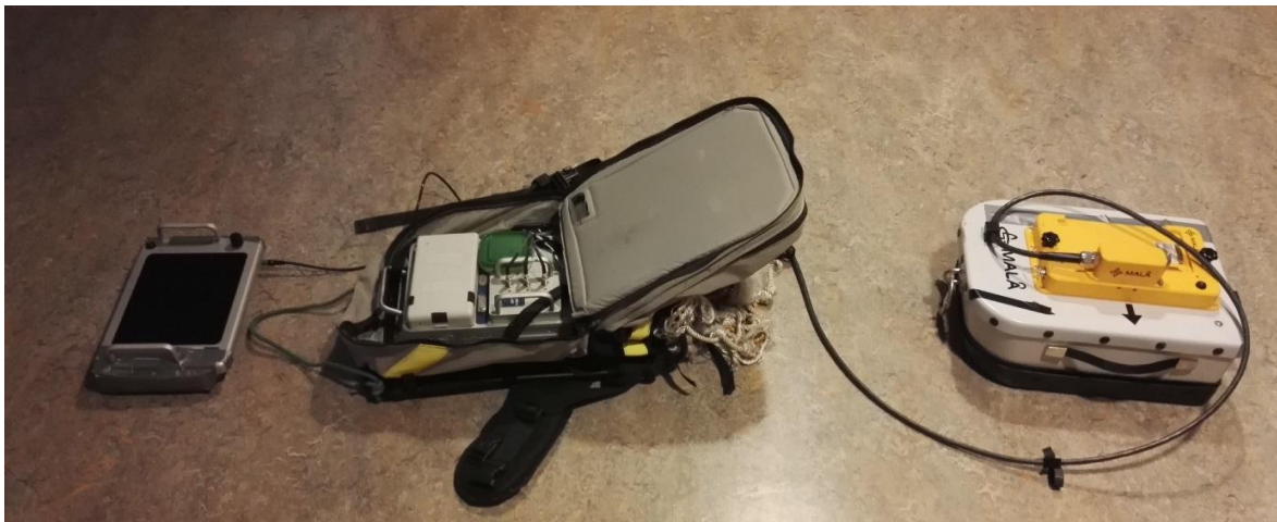
Figur 17: Georadar fra MALÅ: Fra venstre: Monitor – Kontrollenhet - Antenne
