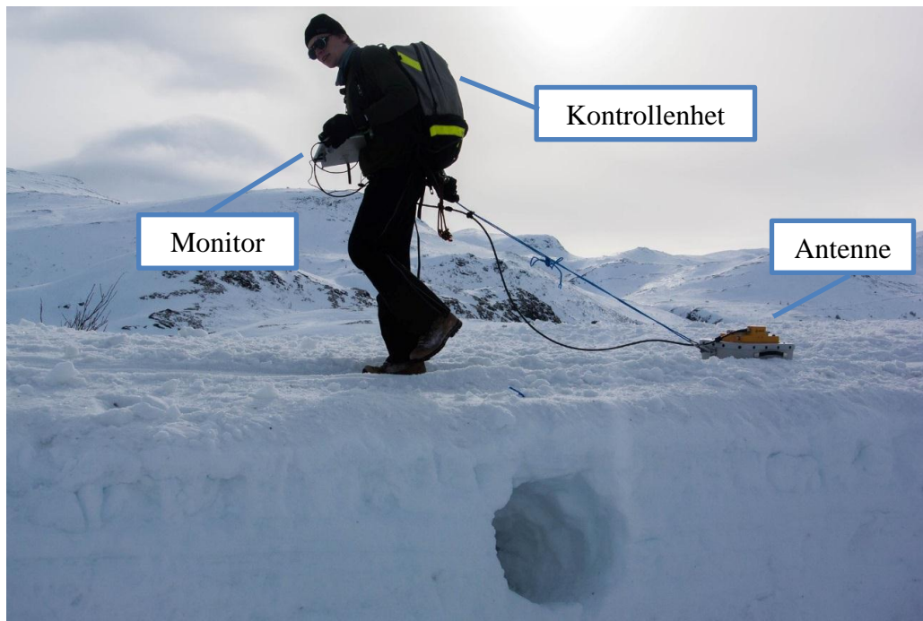
Figur 18: Figuren viser oppsett av georadar under undersøkelsene: 500 MHz antenne til høyre, koblet med tau til sekk (kontrollenhet) for å beskytte kablene. Monitor med koblinger til venstre.
