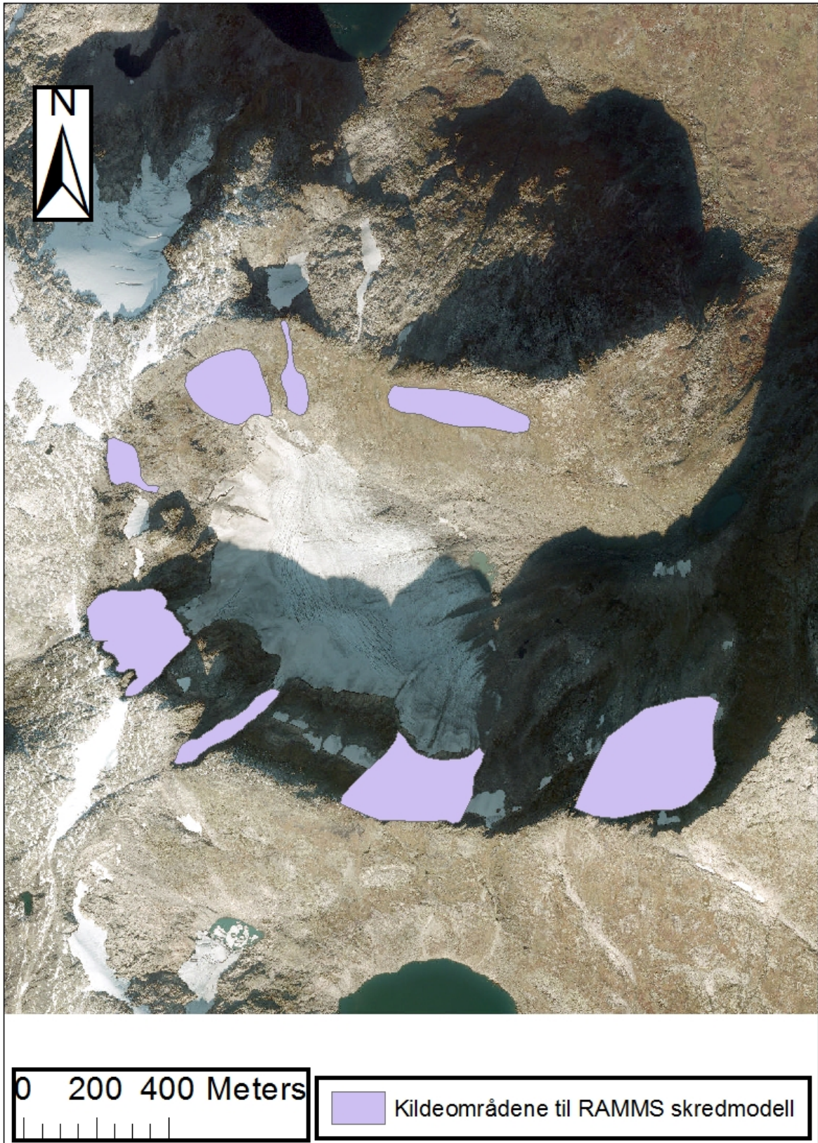
Figur 23: Kildeområdet for potensielle snøskred. «Kildeområdene til RAMMS skredmodell» inneholder data om areal til kildeområdet, høyden på bruddkanten og friksjonen til skredet.
