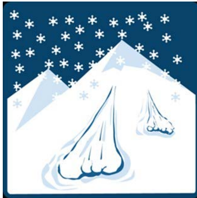
Figur 11: Illustrasjon av løssnøskred. Figuren viser hvordan løssnøskred starter fra et punkt og utbres i en «pæreform». Bildet er hentet fra Varsom.
