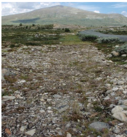
Bilde 10. En av vegkantene som inngikk i feltundersøkelsen med tilsådd felt (lengst unna) og ikke tilsådd felt (nærmest).
