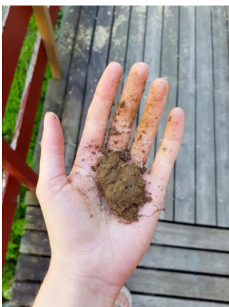
Figur 57: Jordanalysene samler seg i en ball når den har blitt komprimert sammen.
