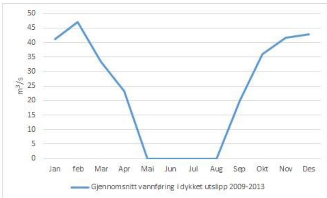
Figur 12: Gjennomsnitt vannføring i dykket utslipp til Aurland 1V. Data hentet fra NVEs målestasjon 72.37.0.
