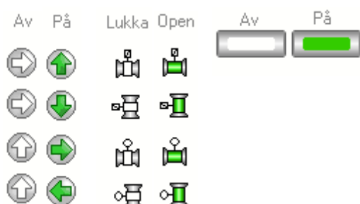
FIGUR 5: KOMPONENTSYMBOL (PUMPE, VENTILAR OG UV-FILTER)
