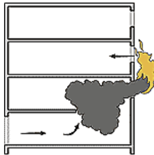
Figur 15 - Brannspredning gjennom vindu til fasaden (25)
