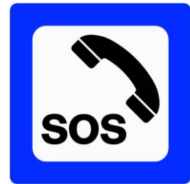
Figur 5: Eksempel på merking av nødtelefon i tunnel [89].
