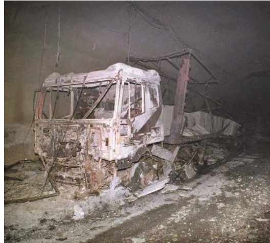
Figur 19: Rester av et vogntog etter brannen i Mont Blanc i 1999 [94].
