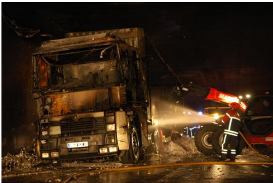
Figur 23: Vogntoget som tok fyr i Fréjustunnelen i 2005 [87].
