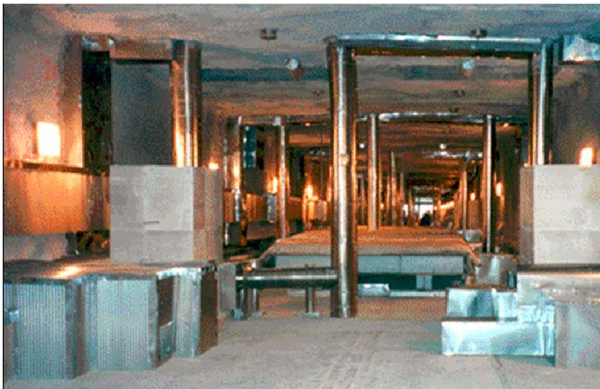
Figur 4.7: Tunnel sett fra nord til sør. I front til venstre og høyere ser en hastighets- og datainnsamlingskabinetter, etterfulgt av måletre og brannkarene bakerst på bilde [19]
