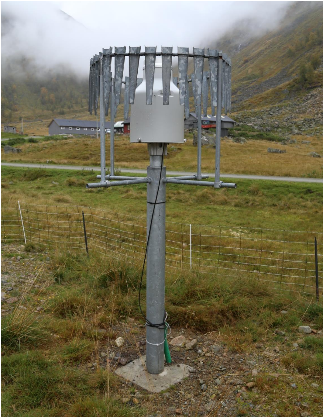
Bilde 3: Metallbitene som henger rundt nedbørsbøtten skal dempe vindkast slik at eksakt akkumulert nedbør blir registrert. Bildet er tatt i september 2014. Fotograf: Kevin Saurin
