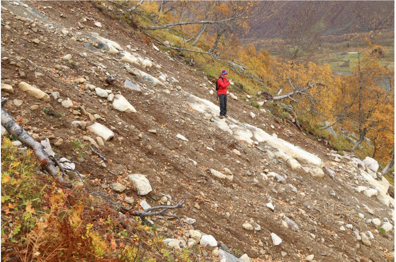
Bilde 8: Sone 1. Dette er øverst i skredløpet ved ca. 660 m o.h. her er skredbanen ca. 30 m bred, og vi ser at personen på bildet står på en fjellblotting. Materialet som ligger igjen i skredbanen ligger som små rygger og stiper. Bildet er tatt i november 2014. Fotograf: Kevin Saurin.
