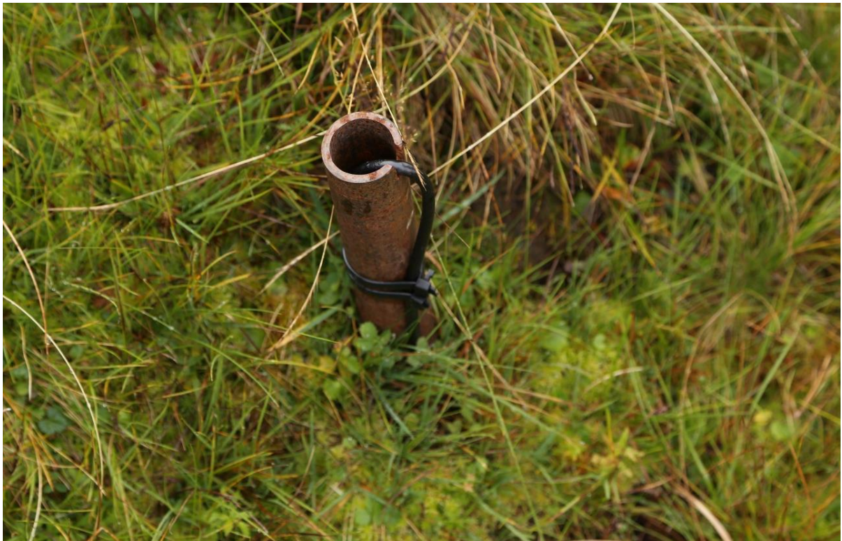
Bilde 4: Grunnvannsrør 2 til NVE som er plassert i skråningen. Måleren som registrerer grunnvannsnivå og grunnvannstemperatur henger i ledningen. Vi har tatt av lokket som til vanlig står over grunnvannsrøret for å se ned. Fotograf: Kevin Saurin.
