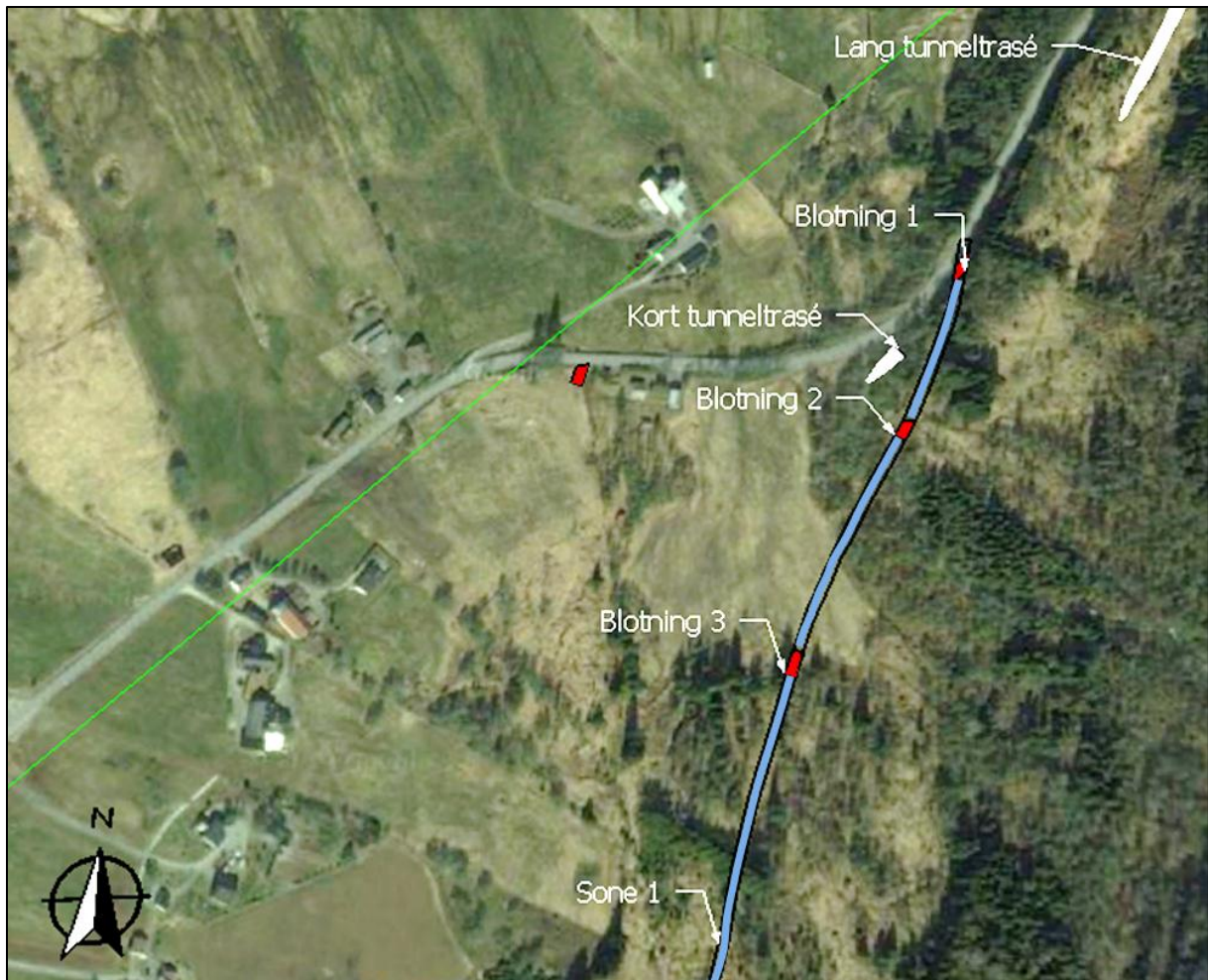
Figur 28: Figuren viser 3D-modellen fra fugleperspektiv. Her ser vi blotninger (rødt) med forvitret fjell, der blotning 1, blotning 2 og blotning 3 følger «svak sone 1» (blå sone).
