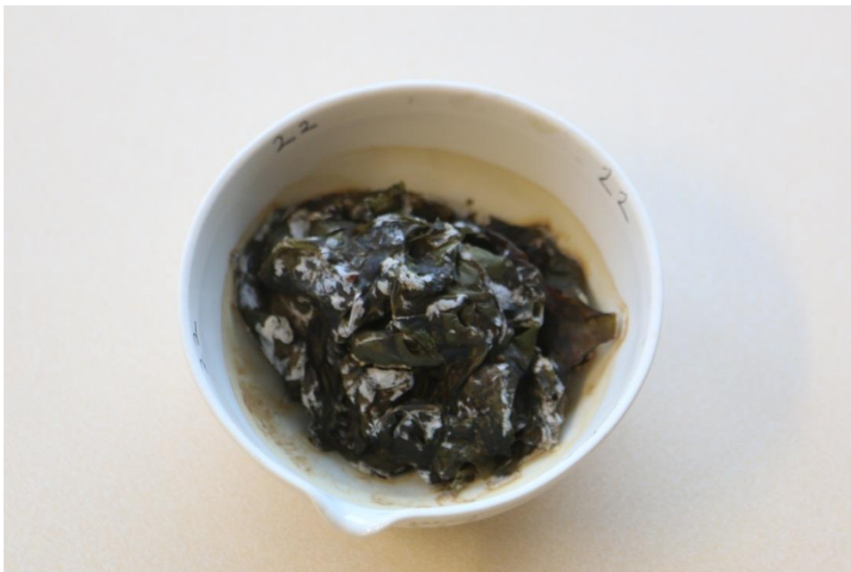
Figur 33: Salt og mulig mannitol (hvitt overflatepulver) som er skilt ut etter tørking.
